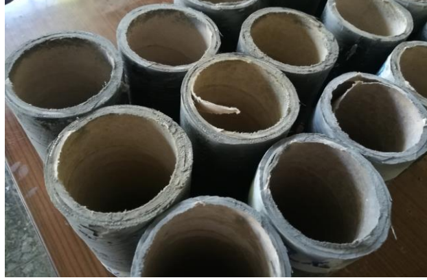
Şekil 3.19. Karton kalıp ile beraber kesilen numuneler
