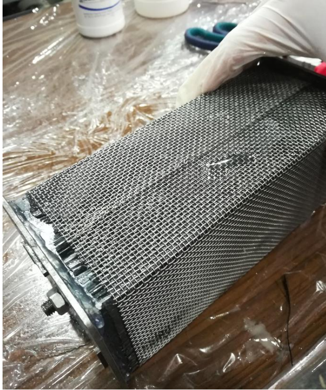
Şekil 3.9. Kalıp yüzeyine sarılan örgü tel takviye malzemesi
