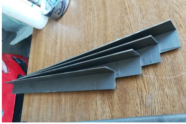
Şekil 3.13. Köşe kısımlara konulan L şeklindeki çelik sac parçaları
