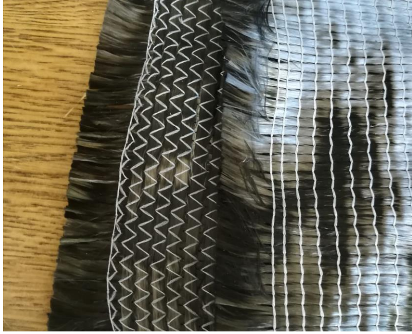
Şekil 3.3. Karbonfiber takviye malzemesi (Çift eksenli (biaxial) karbon fiber kumaş-408 gr/m 2 )
