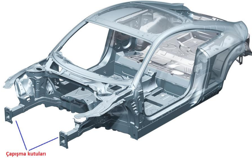
Şekil 1.2. Bir aracın iskelet yapısı ve çarpışma kutuları
