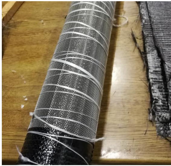
Şekil 3.18. Örgü tel ile kaplanmış ve ip ile bağlanmış numune
