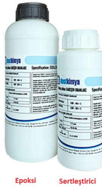
Şekil 3.4. Matris malzemesi olarak kullanılan epoksi reçine ve sertleştirici
