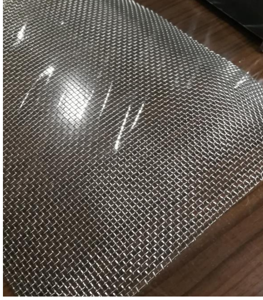
Şekil 3.5. Takviye malzemesi olarak kullanılan paslanmaz örgü tel
