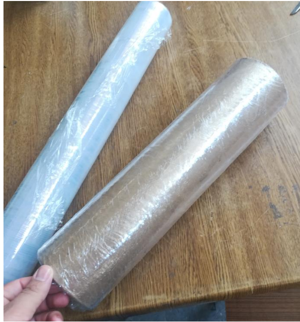
Şekil 3.16. Jelatin ile kaplanan karton boru
