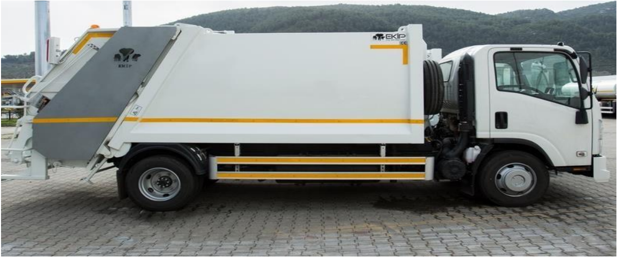
Şekil 4.9. Hidrolik Sıkıştırırmalı Çöp Kamyonu (7+1 m 3 )
