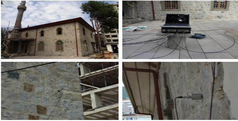
Şekil 3.5. Büyük Gülbahar Camisi ivmeölçer yerleşimleri ve veri toplama sistemi (Çalık ve ark. 2013).
