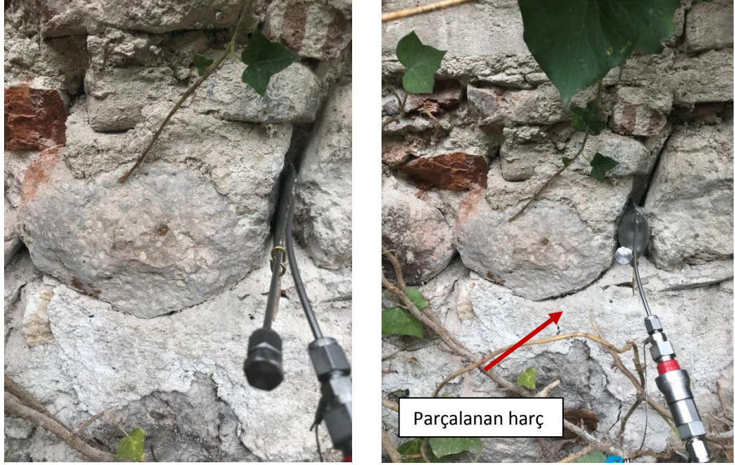
Şekil 3.18. Shear testi öncesi ve sonrasında harçtan sıyrıldığı ana ait fotoğraflar
