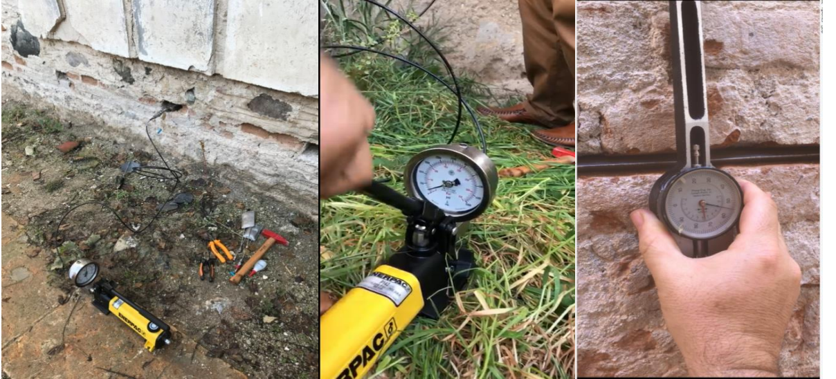
Şekil 3.17. Flatjack test uygulamasına ait fotoğraflar
