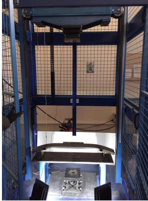
Şekil 3.18. Serbest Düşme Mekanizması
