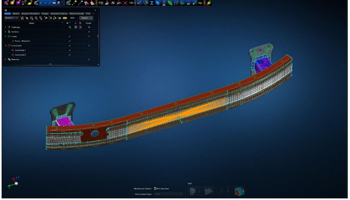
Şekil 3.3. Ön Tampon Tasarımlarının Sonlu Elemanlar Modelindeki Yük Uygulama Noktaları
