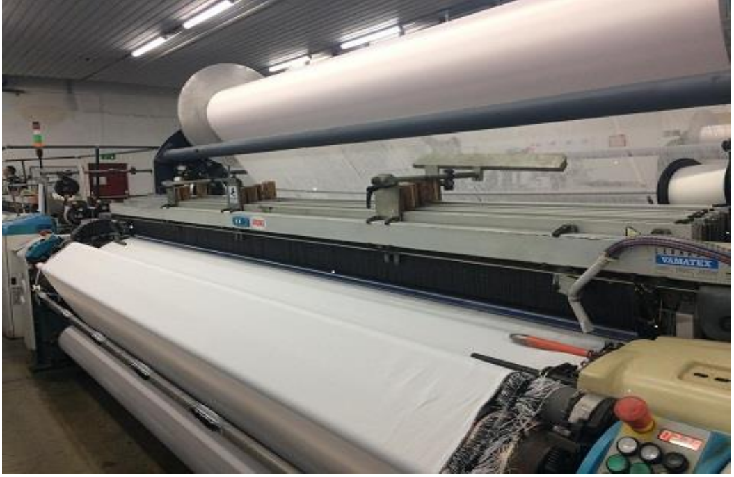
Şekil 3.2. Numune kumaşların üretildiği Vamatex armürlü dokuma makinesi
