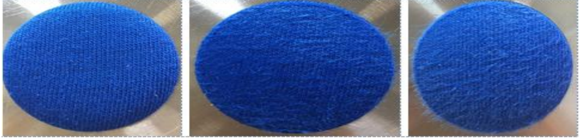
Şekil 4.8. Viskon lifinin sırasıyla, işlem görmemiş, 5 000 ve 10 000 devirdeki görüntüleri
