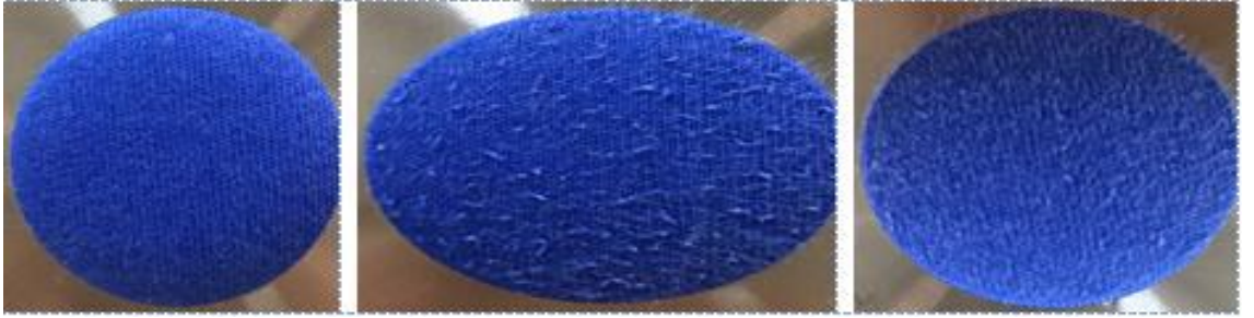
Şekil 4.9. Pamuk lifinin sırasıyla, işlem görmemiş, 5 000 ve 10 000 devirdeki görüntüleri
