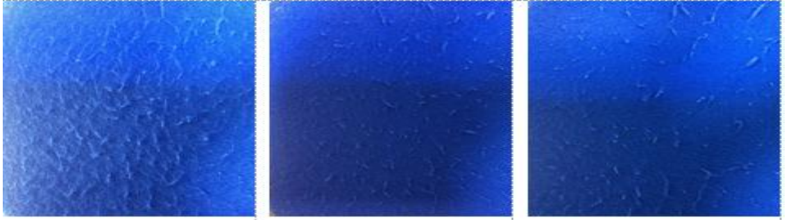
Şekil 4.2. Polyester lifinin sırasıyla 10 000, 20 000 ve 30 000 devirdeki yüzey görüntüleri
