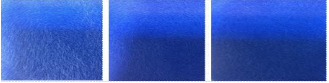
Őekil 4.4. Pamuk lifinin sırasıyla 10 000, 20 000 ve 30 000 devirdeki yzey grntleri
