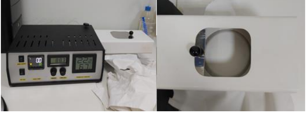
Şekil 3.5. Su buharı geçirgenliğinin ölçüldüğü Permetest cihazı ve su buharı geçirgenliği ölçümünde numunenin yerleştirildiği kapaklı kısım
