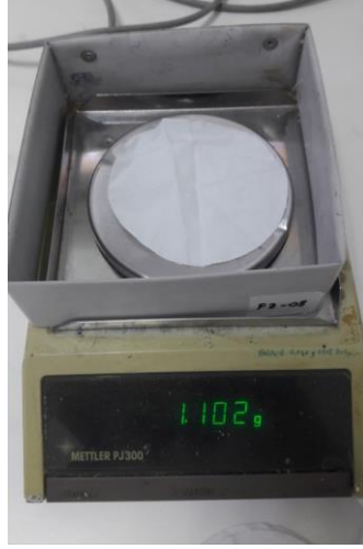
Şekil 3.3. METTLER PJ300 cihazı ile numune gramajının ölçümü
