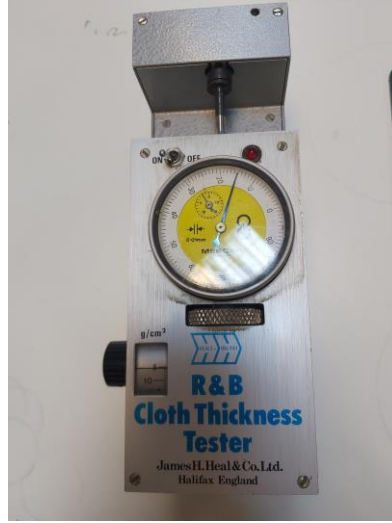
Şekil 3.7. Gömlek kumaşlarının kalınlığını ölçmede kullanılan cihaz
