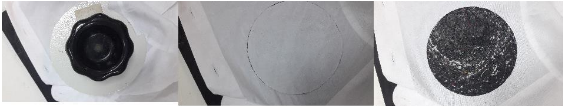
Şekil 3.2. Dairesel numune kesici şablon ile numune hazırlanışı
