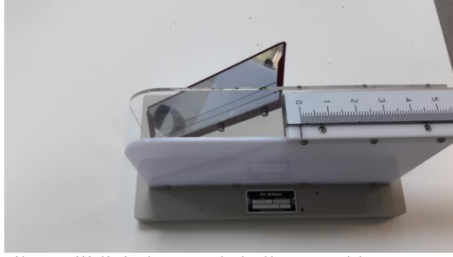
Şekil 3.8. Kumaş Eğilme Rijitliği ölçümünde kullanmış olduğumuz SDL ATLAS marka M003B model cihaz
