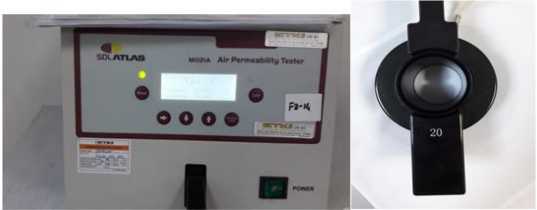
Şekil 3.4. Hava geçirgenliği ölçümünün yapıldığı SDL ATLAS M021A Air Permeability Tester cihazı ve 20 cm 2 'lik deney alanının görüntüsü
