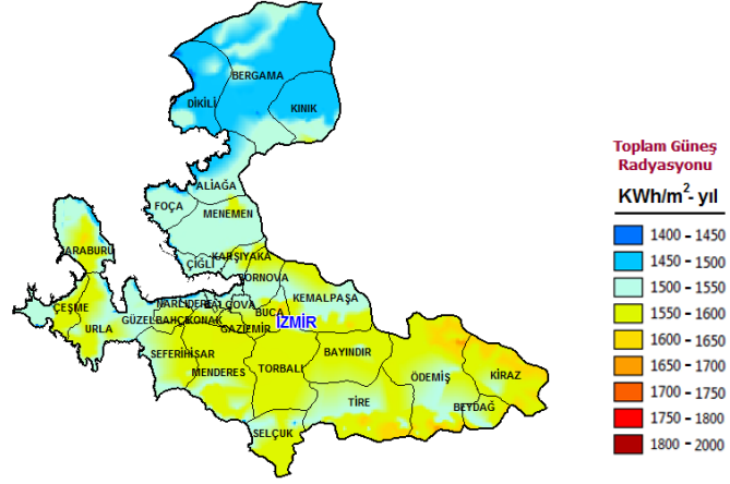
Şekil 3.15. İzmir güneş ışınımı yoğunluğunun ilçelere göre dağılımı (Anonim 2018j)
