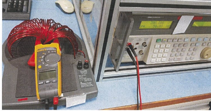
Şekil 4.25. Pens ampermetre AC voltaj kalibrasyonu
