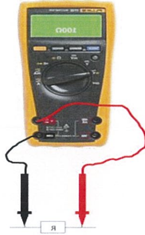
Şekil 3.12. Direnç ölçümünde multimetre prob uç bağlantısı (Anonim 2015b)
