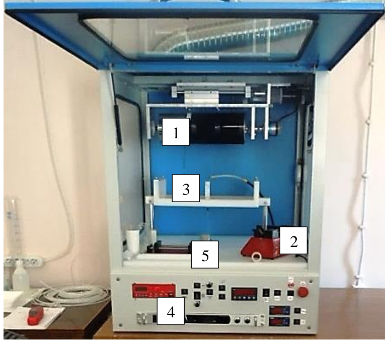
Şekil 3.2. Çalışmada kullanılmış olan dikey elektrospinning cihazının silindir toplayıcı montajlı görüntüsü (1 silindir toplayıcı, 2 taşınabilir şırınga pompası, 3 iğne, 4 kontrol ünitesi ve güç kaynağı, 5 cihaza bütünleşik şırınga pompası)
