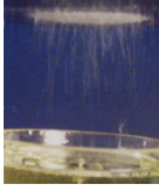
Şekil 2.8. Polivinilpirolidon (PVP) çözeltisinden çıkan çoklu jetler (Liu ve ark. 2008)
