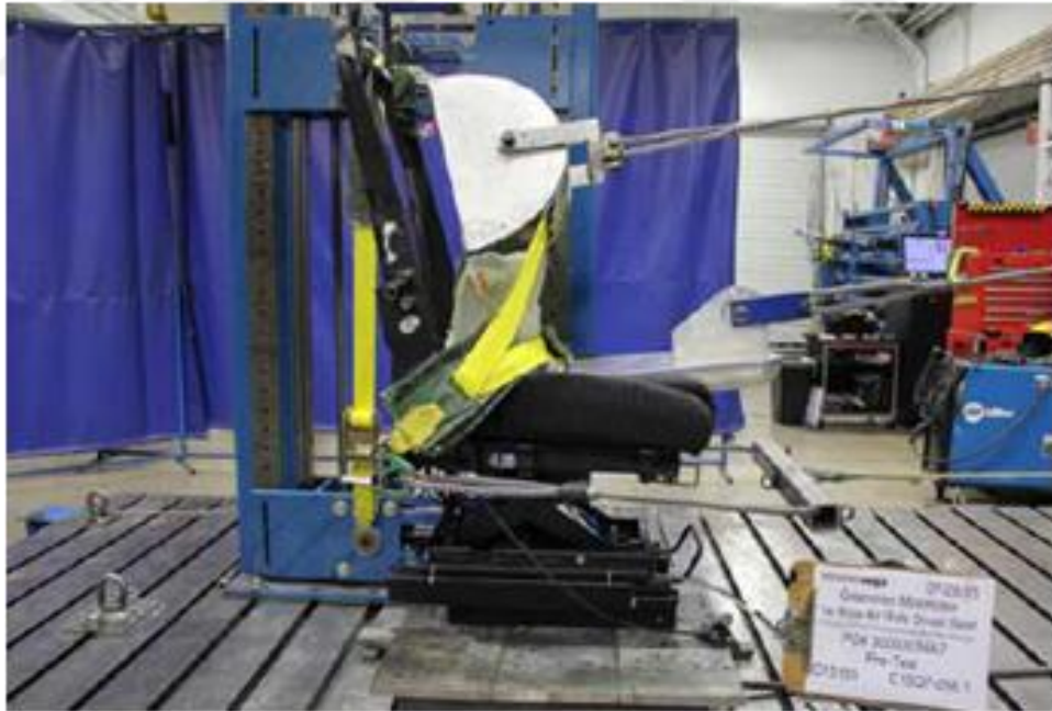
Şekil 4.34. Test C15155 Sonrası Koltuğun Durumu (FMVSS 1994)
