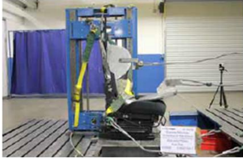
Şekil 4.38. Test A16008 Sonrası Koltuğun Durumu (FMVSS 1994)
