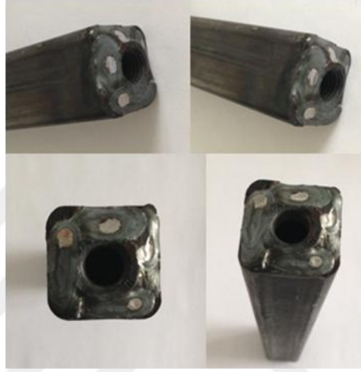
Şekil 4.3. Kaynak dikişi uygun olmayan ICP bar tasarımı
