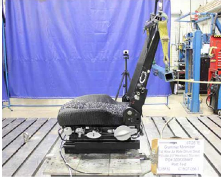
Şekil 4.32. Test C15152 Sonrası Koltuğun Durumu (FMVSS 1994)
