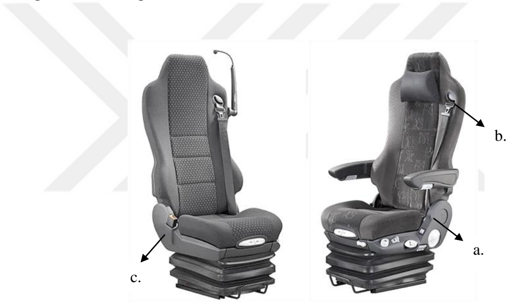
Şekil 3.1. Mevcut sürücü koltuğu üç noktalı emniyet kemeri bağlantı noktaları a. Emniyet kemeri başlangıç noktası, 1. nokta b. Emniyet kemeri yuvarlanma noktası yada efektif nokta, 2. nokta c. Kemer tokası bağlantı noktası, 3. nokta
