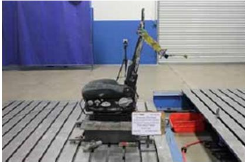
Şekil 4.36. Test A16005 Sonrası Koltuğun Durumu (FMVSS 1994)
