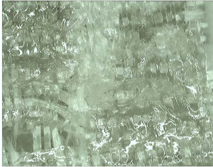
Şekil 6: Çekme testi sonucu meydana gelen deformasyon
