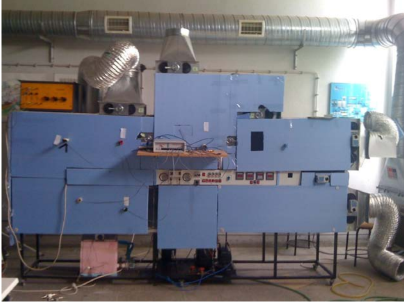
Şekil 1: Isı pompası destekli kurutma ünitesi deney ünitesi
