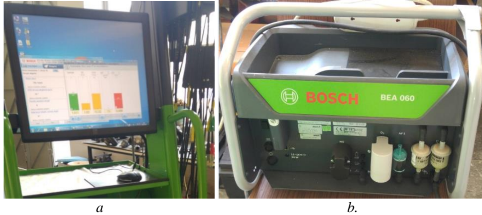
Şekil 2: a. Egzoz emisyon değerleri okunduğu ekran b. Egzoz analiz cihazı
