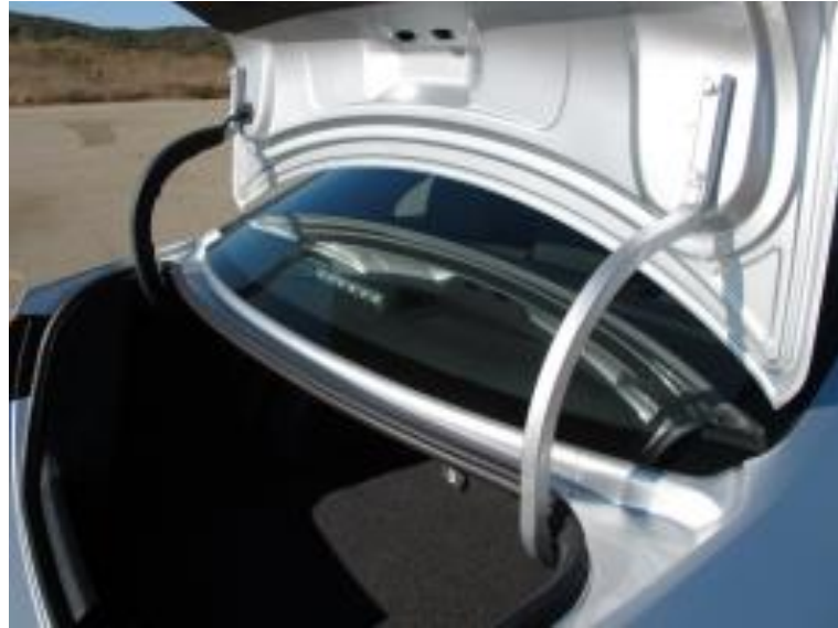
Şekil 2.5. Sedan araçlarda kullanılan kuğu boynu bagaj kapağı menteşesi ( http://forums.vwvortex.com , 2017)
