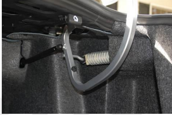
Şekil 2.10. Çekme yaylı ve gazlı yay takviyeli kuğu boynu bagaj kapağı menteşesi ( http://forums.vwvortex.com , 2017)
