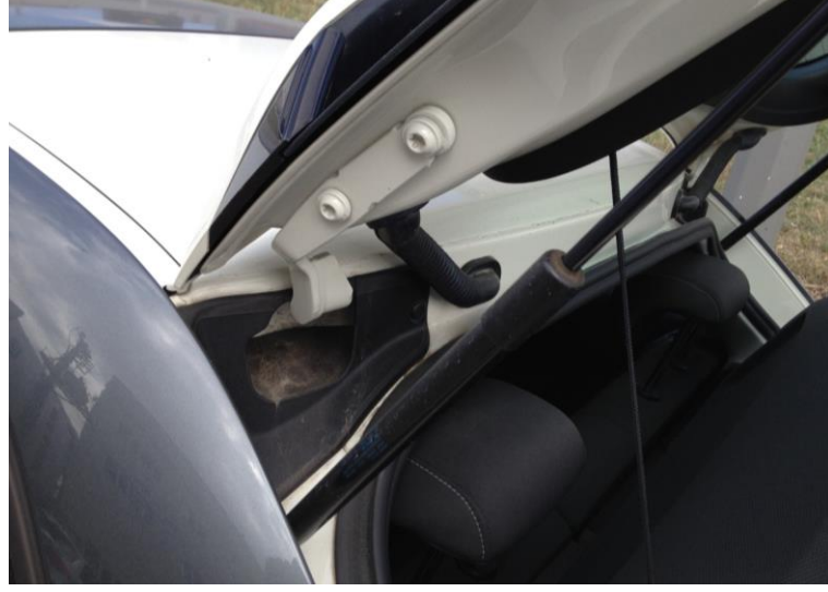
Şekil 2.4. Hatchback araçlarda kullanılan iki kollu bagaj kapağı menteşesi
