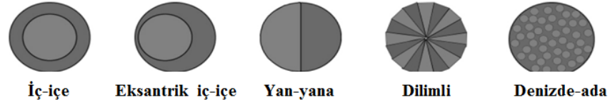
Şekil 2.8. Çeşitli bikomponent liflerin enine kesit görüntüleri (Anonim 2017d)
