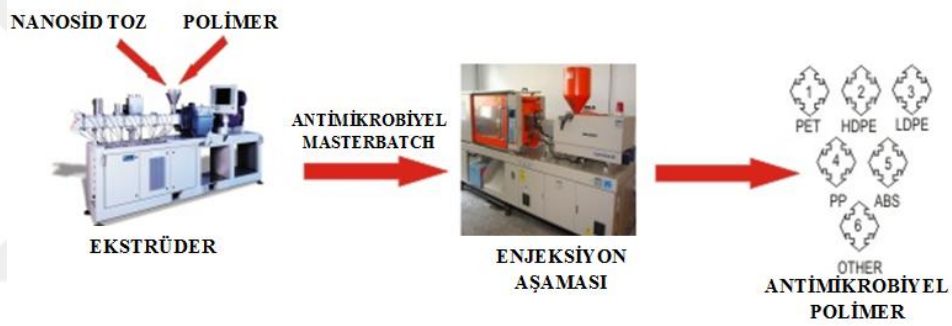
Şekil 2.7. Lif çekim işlemi sırasında ekstreder içerisine antimikrobiyel kimyasallar eklenmesi sayesinde antimikrobiyel özellik kazandırılması işlemi olarak düşünülebilen masterbatch işlemi (Anonim 2017c)
