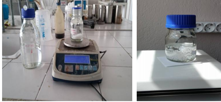
Şekil 3.4. Polimer çözeltilerinin hazırlanması (solda) ve manyetik karıştırma tekniğiyle polimerin çözdürülmesi (sağda)
