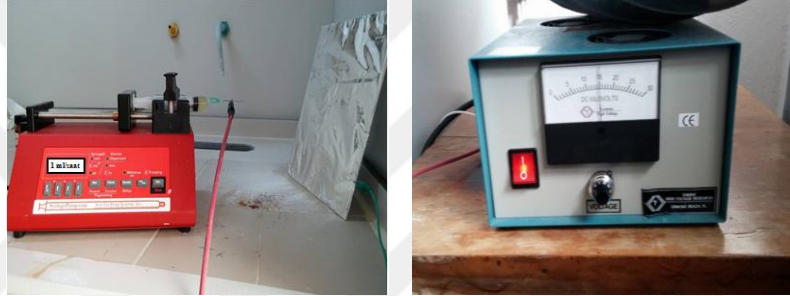
Şekil 3.5. Elektroçekim prosesinde kullanılan mikropompa (solda) ve voltajın uygulandığı güç kaynağı (sağda)
