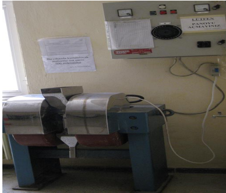
Şekil 2: Laboratuvar çaplı yüksek alan şiddetli yaş manyetik ayırıcı zenginleştirme cihazı
