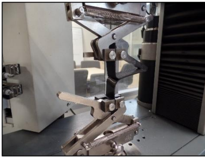
Şekil 8: Numunelere uygulanan yapışma kuvvetinin ölçülmesi
