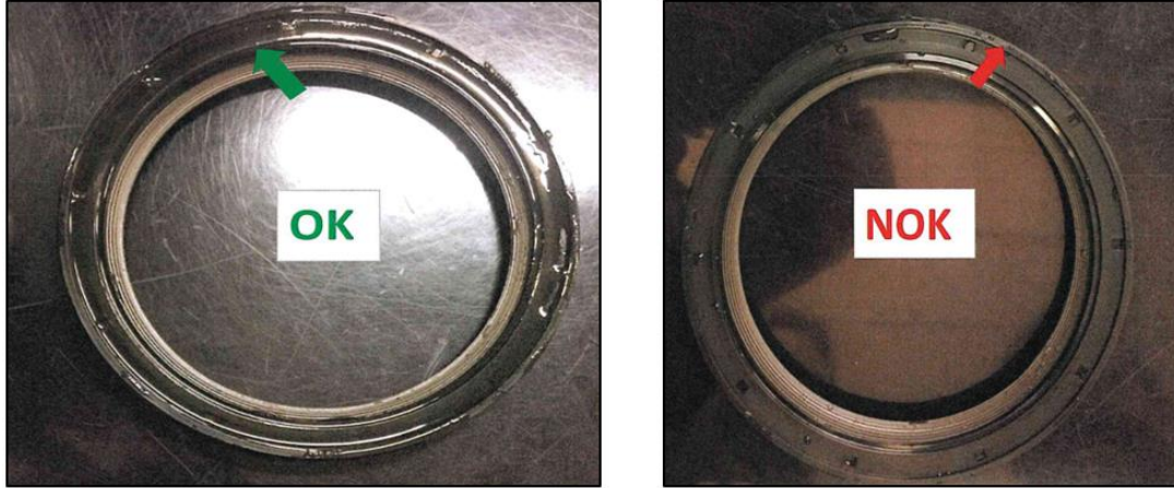
Şekil 9: Atmosferik plazma uygulanmış parçalar için su kırılma testi
