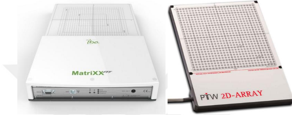
Şekil-21 Farklı üretici firmaların iki boyutlu iyon odaları
