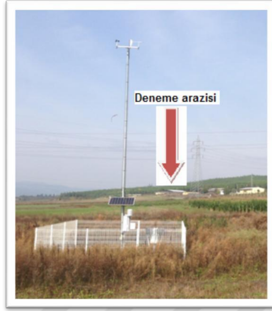
Şekil 3.10. Arazi çalışmalarında iklim verilerinin elde edildiği iklim istasyonu.
