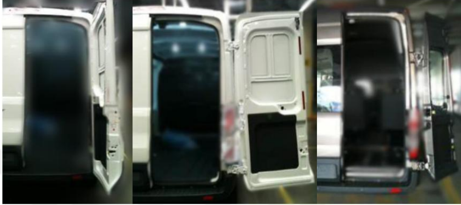
Şekil 2. 90-180 ve 270 derece açılan araç kargo kapı görüntüsü
