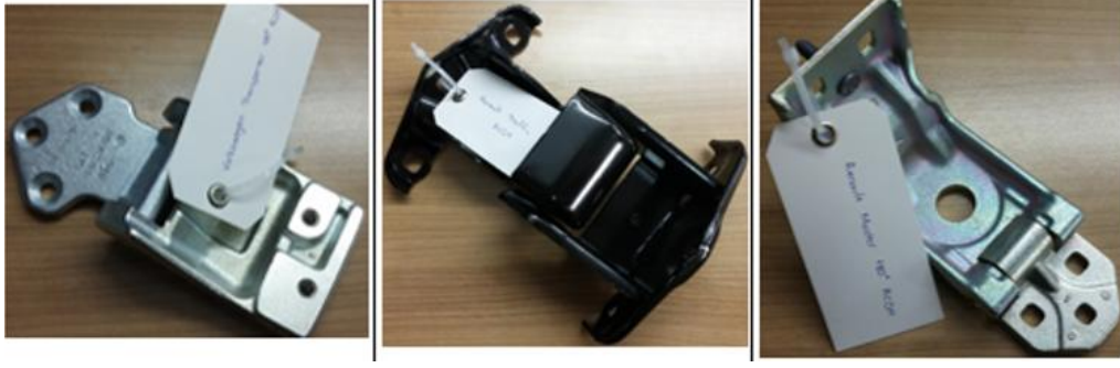
Şekil 11. Vw transporter, renauld trafic, renauld master arka kargo kapı menteşeleri
