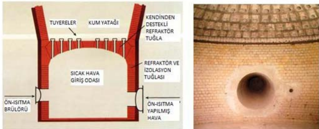
Şekil 3.30. Sıcak Hava Giriş Odası Kesiti
