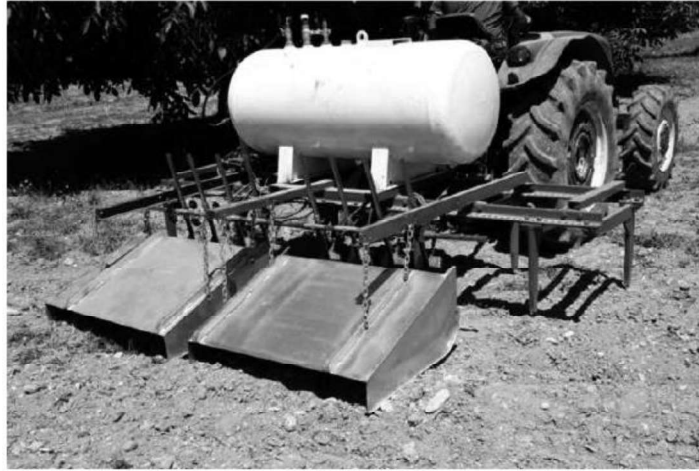
Şekil 3.2. Saksı denemesinde kullanılan yüzey alev makinesi (Arslan ve ark., 2016)
