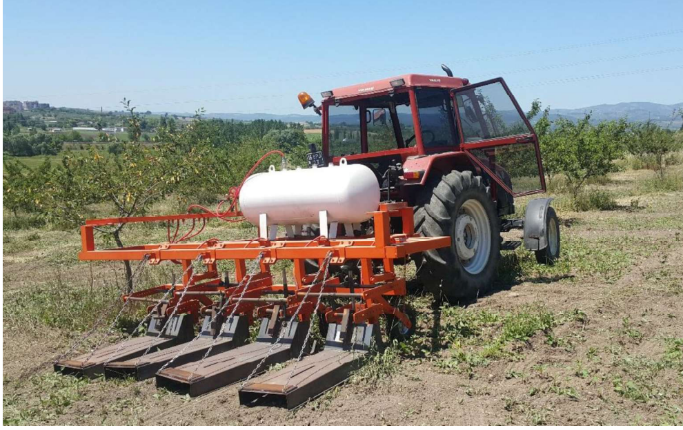
Şekil 3.3. Tarla denemelerinde kullanılan traktör ve 4 sıralı alev makinesi (Asan, 2019)
