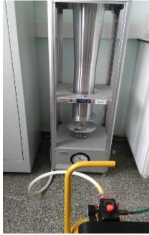
Şekil 3.16. Petri-yaprak testinde kullanılan Burkard marka ilaçlama kulesi.
