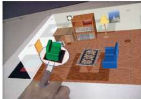
Şekil 2.4. Kullanıcı modelleri almak, taşımak, bırakmak ve yok etmek için gerçek bir kürek kullanır
