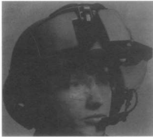
Şekil 2.6. Hughes Electronics tarafından üretilen iki optik şeffaf HMD
