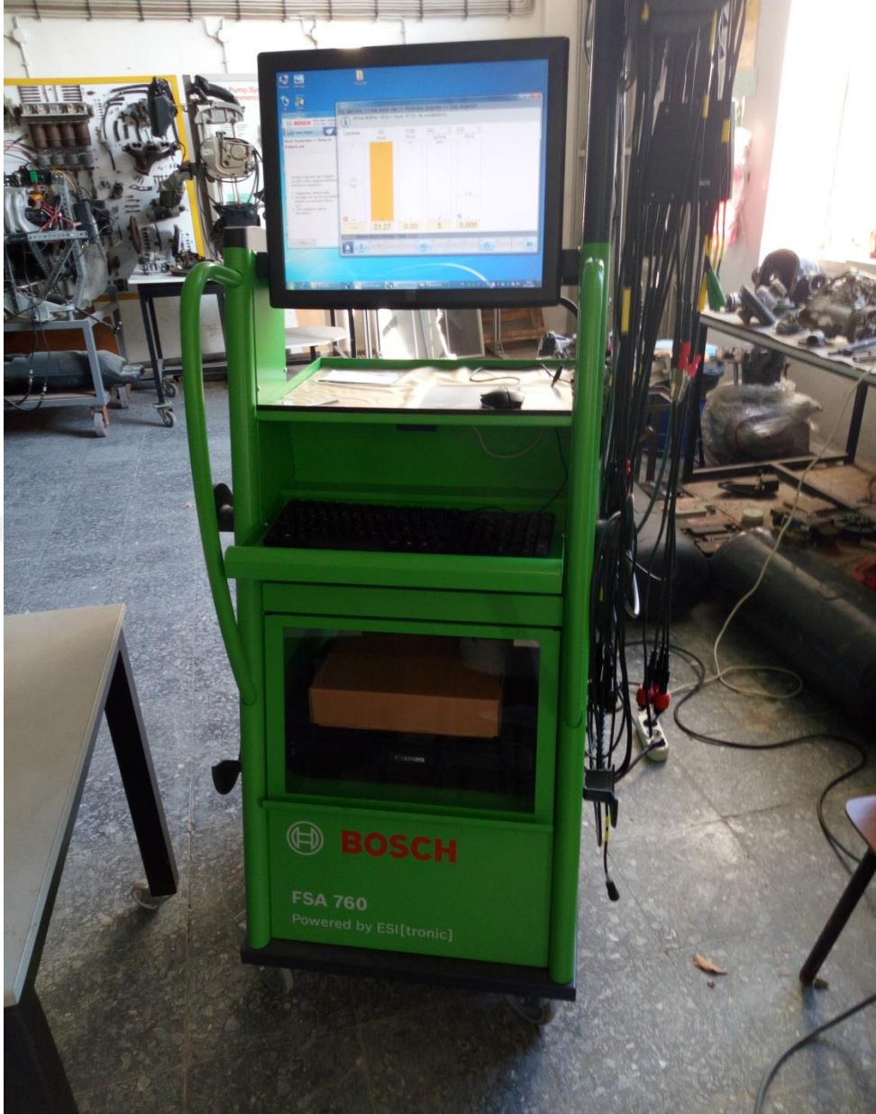
Şekil 3.7. Egzoz emisyonları ölçüm cihazı (FSA 760)
