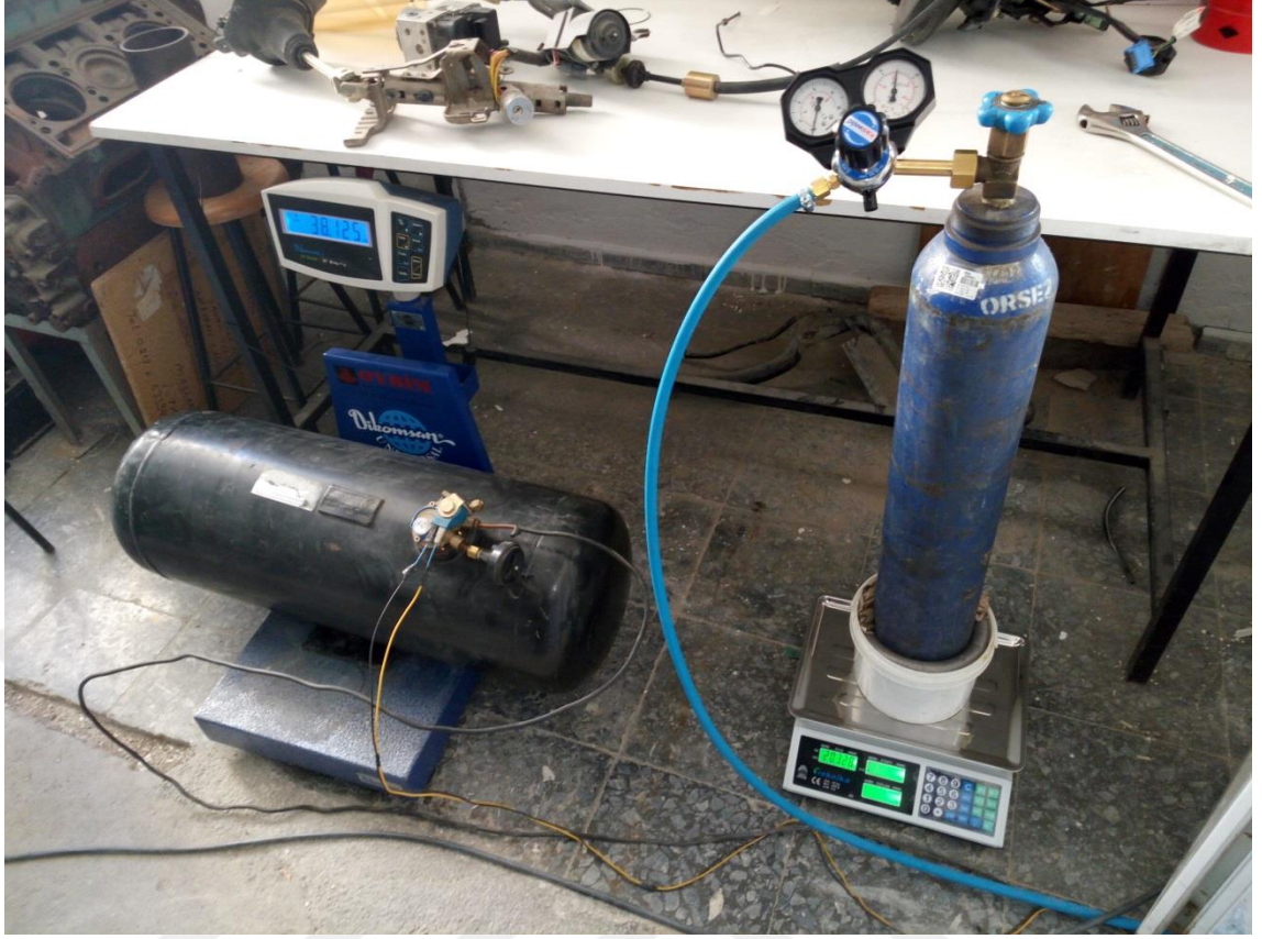
Şekil 3.6. LPG yakıt ve oksijen sarfiyatı ölçüm düzenekleri
