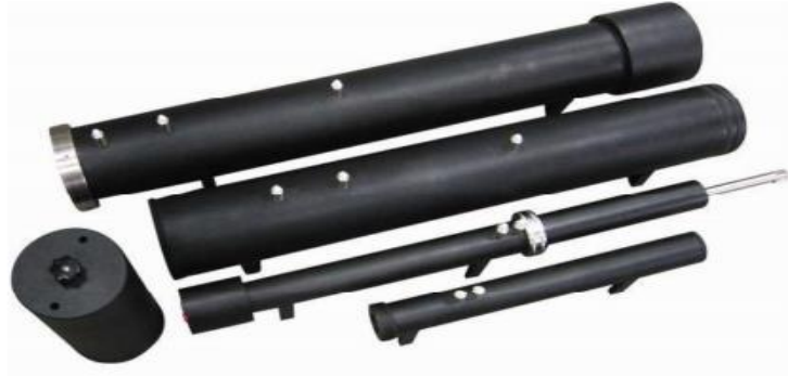
Şekil 3.18. Empedans Tüplerinde Kullanılan Farklı Çaplardaki Tüpler (Anonim 2018 c).
