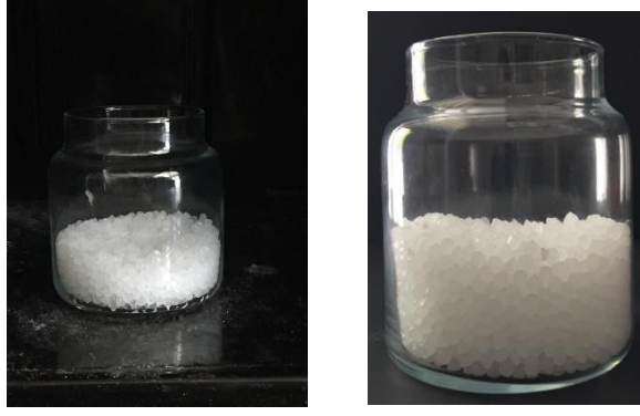
Şekil 3.5. 150 °c de LDPE fırın içinde yerleşmesi.
