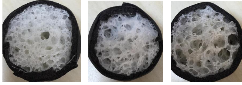
Şekil 3.19. Empedans Tüpünde test yapıldığı 3cm çaplı numuneler.
