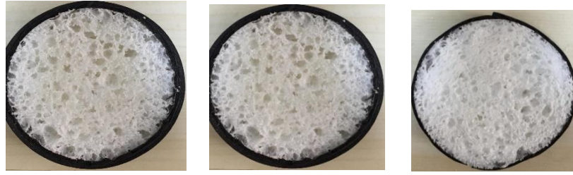
Şekil 3.20. Empedans Tüpünde test yapıldığı 10cm çaplı numuneler.
