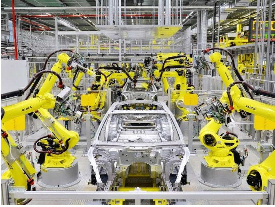
Şekil 2.7. Bir monokok gövde üretim görüntüsü (Anonim 2020 )
