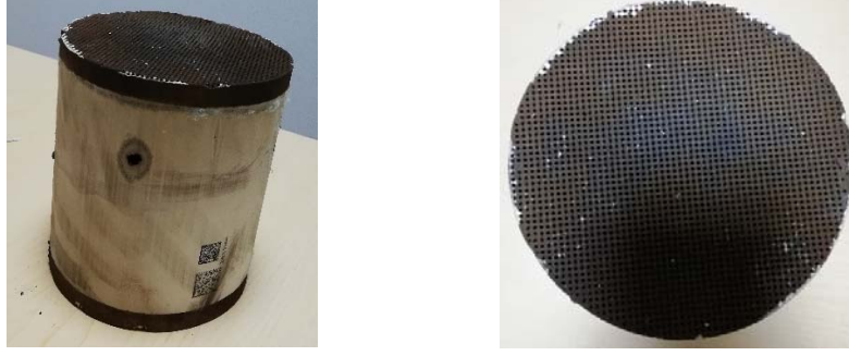
Şekil 4.4. Benzinli aracın katalitik konvertör görseli
