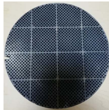
Şekil 4.7. Hibrid benzin ve elektrik motora sahip aracın katalitik konvertör görseli
