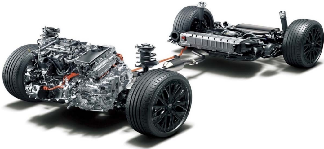
Şekil 2.4. Hibrid motor teknolojisine sahip araç şasisi (Toyota 2017)
