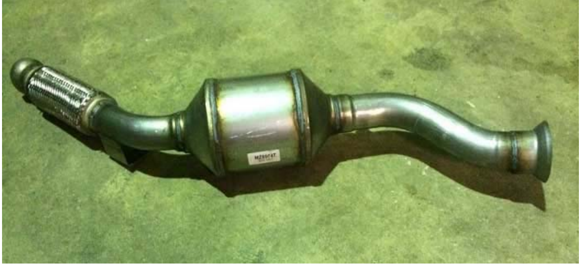
Şekil 2.10. İçten yanmalı benzinli motor katalitik konvertörü (Matay 2016)
