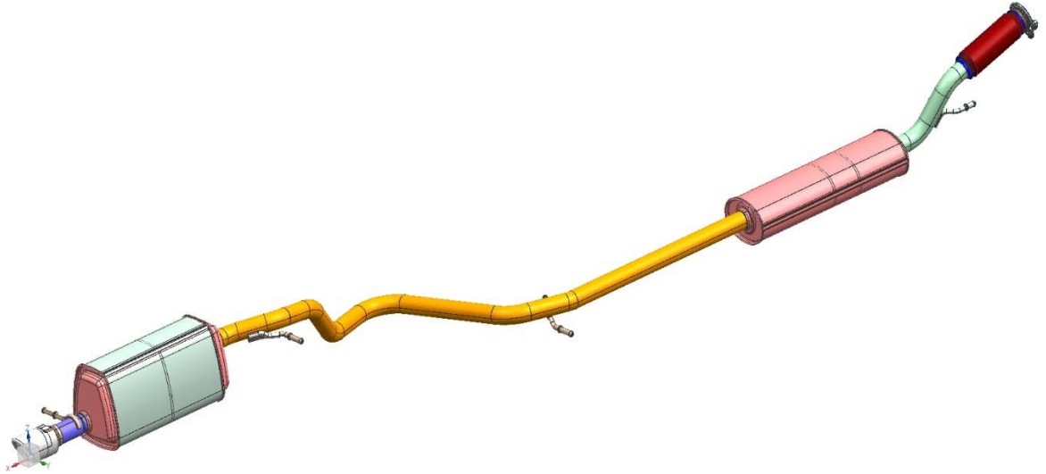
Şekil 4.3. İçten yanmalı bir benzinli motor egzoz emisyon sistemi
