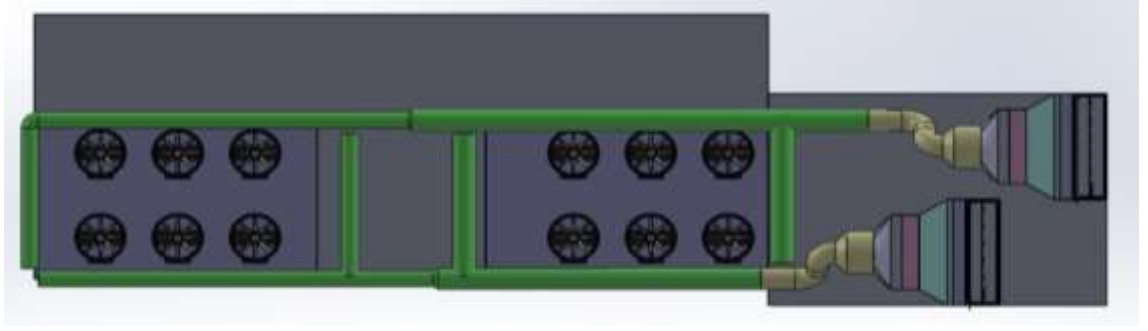
Şekil 3.19. Evaporatif Soğutma Sistemi Modellemesi ( Üst Görünüm)
