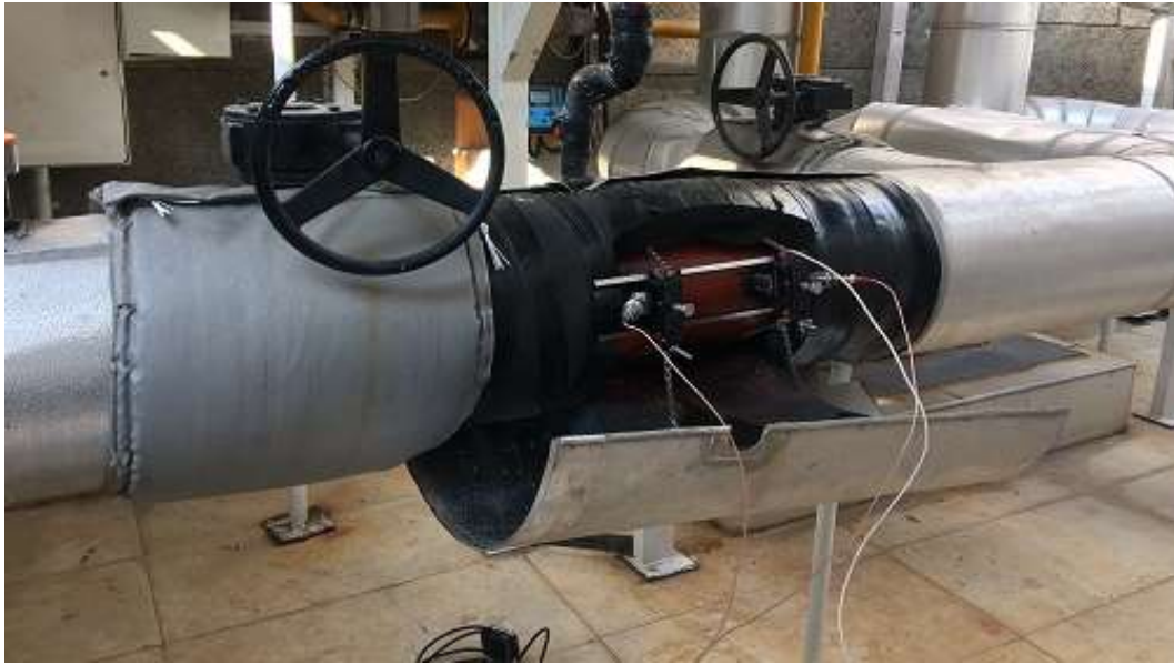
Şekil 4.5. Ultrasonik Debimetre ile Soğutma Miktarı Ölçümü
