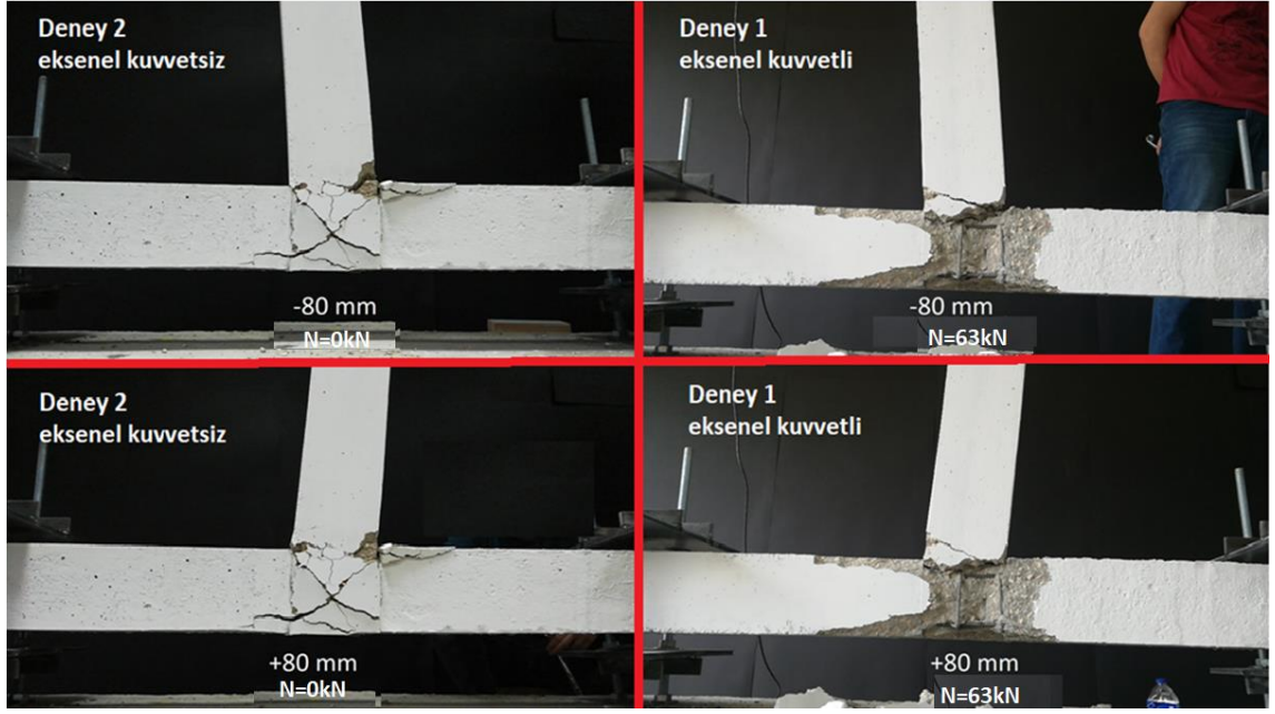
Şekil 4.3. -80/+80 milimetrelik deplasman sonucunda birleşim bölgelerinde oluşan çatlakla (Deney 1 ve Deney 2)
