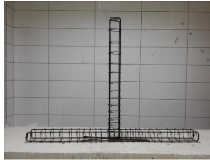
Şekil 3.18. Numunelerin donatı montajının bitmiş hali
