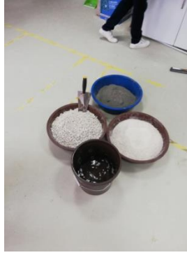
Şekil 3.15. Beton üretimi için gerekli malzemeler(kaba ve ince agrega, çimento, su)
