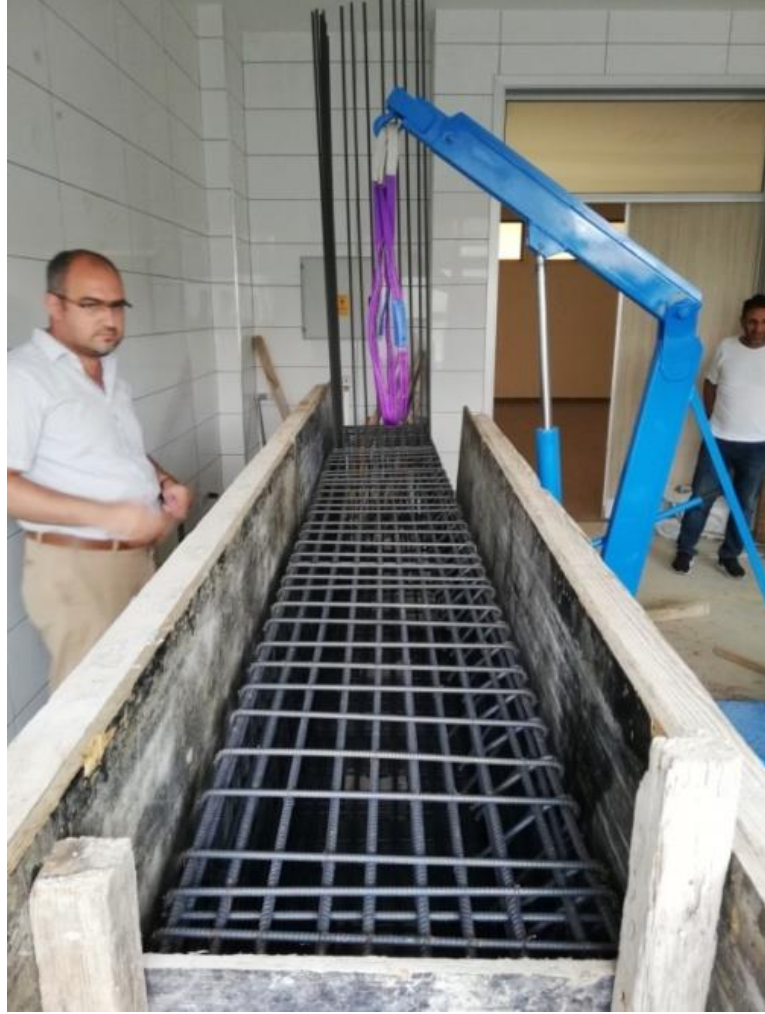
Şekil 3.6. Deney düzeneğinin kalıp montajı ve kiriş donatısının kalıba vinç ile yerleştirilmesi
