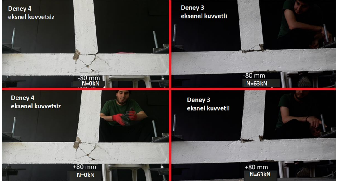
Şekil 4.18. -80/+80 milimetrelık deplasman sonucunda birleşim bölgelerinde oluşan çatlaklar (Deney 3 ve Deney 4)
