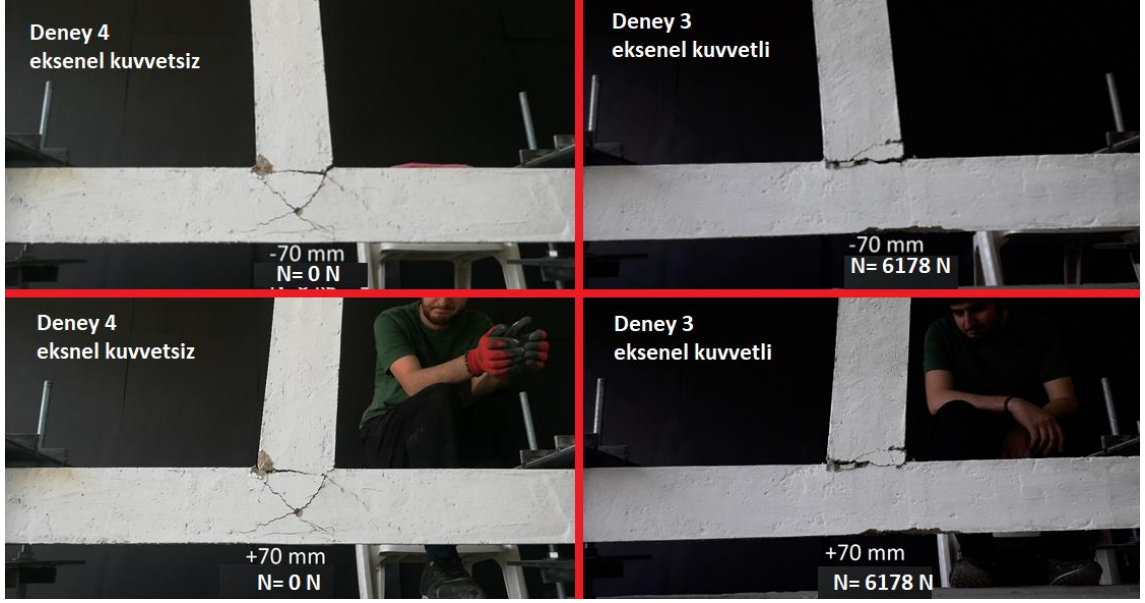
Şekil 4.17. -70/+70 milimetrelık deplasman sonucunda birleşim bölgelerinde oluşan çatlaklar (Deney 3 ve Deney 4)
