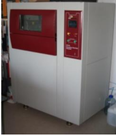
Şekil 3.2. SDL ATLAS M259B Terleyen sıcak plaka sistemi ve cihazın parçaları
