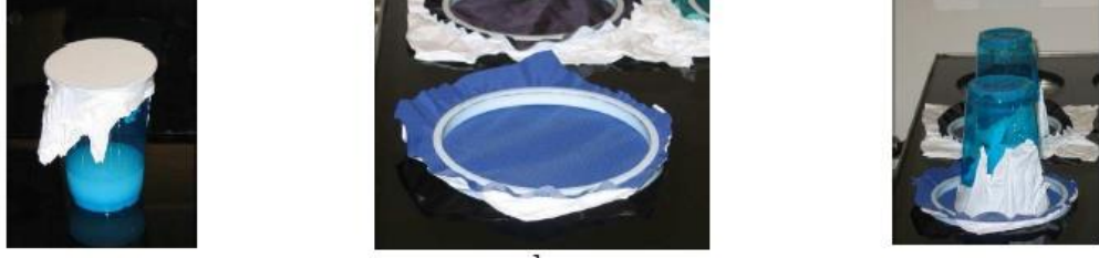
Şekil 2.15. Ters çevrilmiş desikant metodu gösterimi (Arabuli ve ark. 2010)
