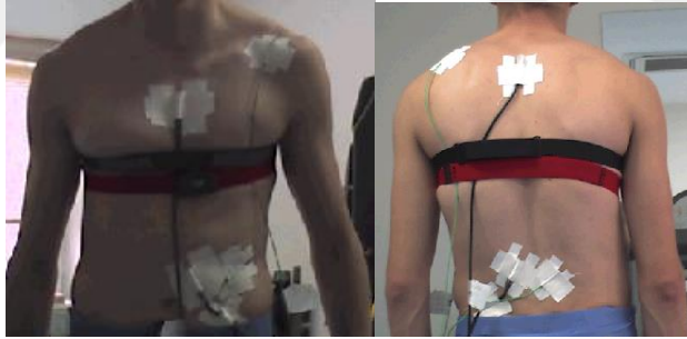
Şekil 3.15. Isı ve nem sensörlerinin vücut üzerindeki yerleşimi
