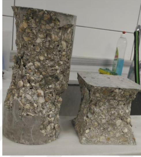
Şekil 4.36. 0,5 S/Ç oranında hazırlanan lif içermeyen 15×30 cm silindir ve 15 cm'lik küp numunelerinin tipik kırılma biçimi
