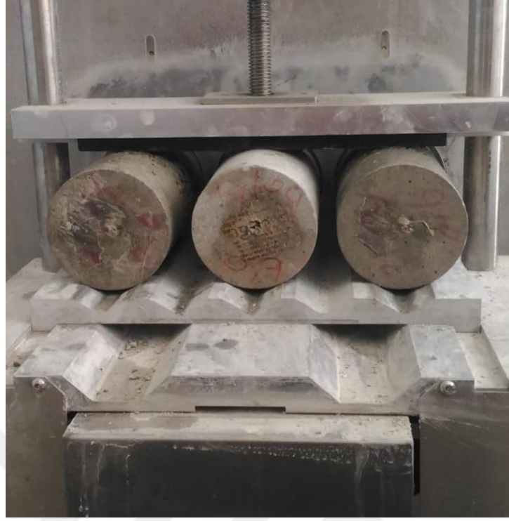
Şekil 3.4. Silindir numune yüzey aşındırma işlemi
