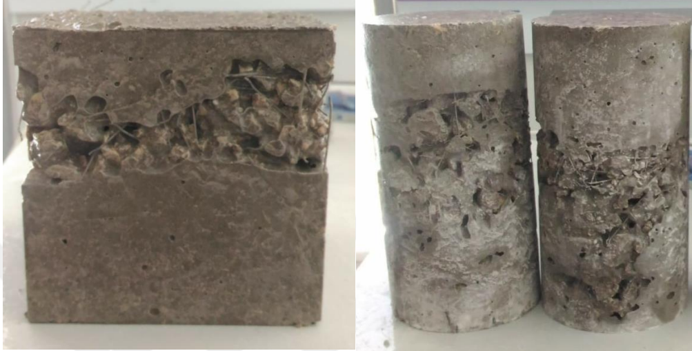
Şekil 4.27. L07 karışımları ile hazırlanan 10 cm küp ve 10×20 cm silindir numunelerde oluşan çeper etkisi
