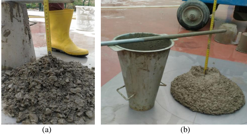
Şekil 3.3. Lif ve lif içermeyen karışımların çökme deneyi a) Lifli karışım b) Lifsiz karışım
