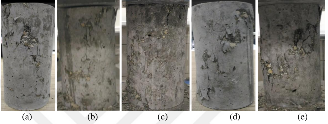
Şekil 4.30. Farklı S/Ç oranlarında hazırlanan %1 lif içeren 15×30 cm'lik silindir beton numunelerinin basınç deneyi sonrası kırılma biçimleri; a) K03 karışımı b) K04 karışımı c) K05 karışımı d) K06 karışımı e) K07 karışımı
