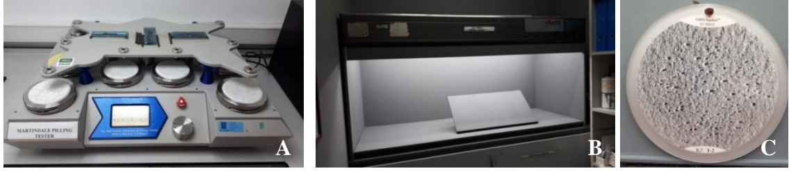
Şekil 3.17. Deneysel çalışmada kullanılan Martindale aşınma ve boncuklanma test cihazı (A), Verivide CAC150 ışık kabini (B) ve EMPA standart SN 198525 fotoğrafı (C)
