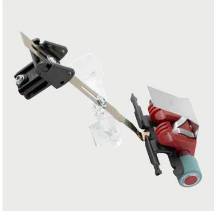
Şekil 2.27. COMPACTeasy sisteminde travers hareketinin kompaktöre iletimi (Anonim 2019h)
