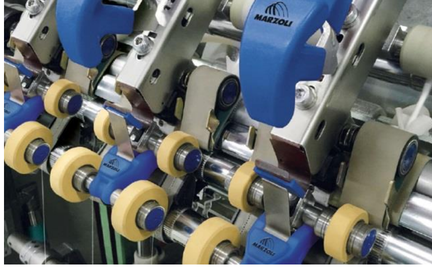
Şekil 2.33. Marzoli Mac 3000 kompakt iplik eğirme sistemi (Ömeroğlu 2016)
