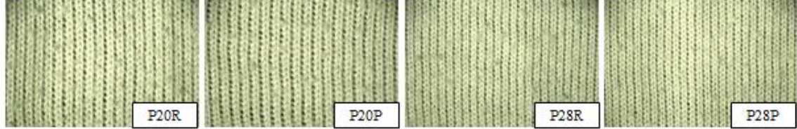
Şekil 4.12. %100 Penye pamuk iplikleri kullanılarak üretilen ham süprem kumaşların boncuklanma sonrası mikroskop altındaki görüntüleri
