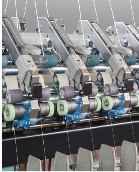
Şekil 2.16. COMPACTdrum kompakt iplik eğirme sisteminin bir görüntüsü (Anonim 2019e)
