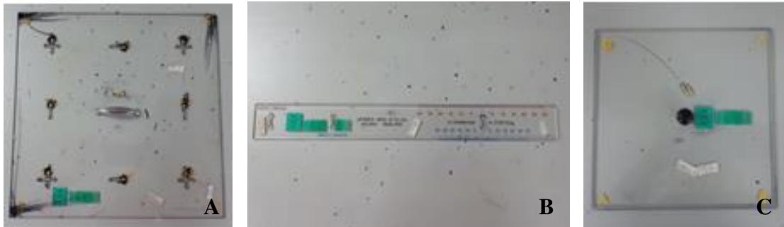
Şekil 3.13. Deneysel çalışmada yıkama sonrası boyutsal değişim testi için işaretlemede kullanılan şablon (A), kumaşların enden ve boydan boyut değişim %'lerini ölçmek için kullanılan cetvel (B), kumaşların dönme %'leri hesaplanırken kullanılan şablon (C)
