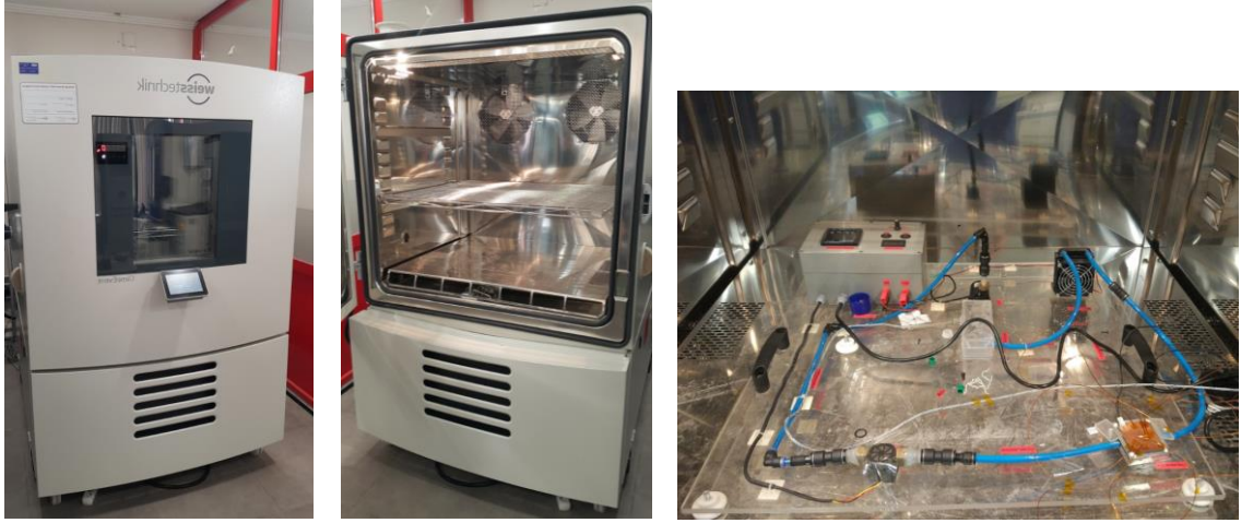
Şekil 3.23. Wiess termal kabin ve test düzeneğinin kabin içi yerleşimi
