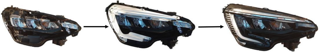
Şekil 3.32. Ön aydınlatma elemanı montaj sıralaması
