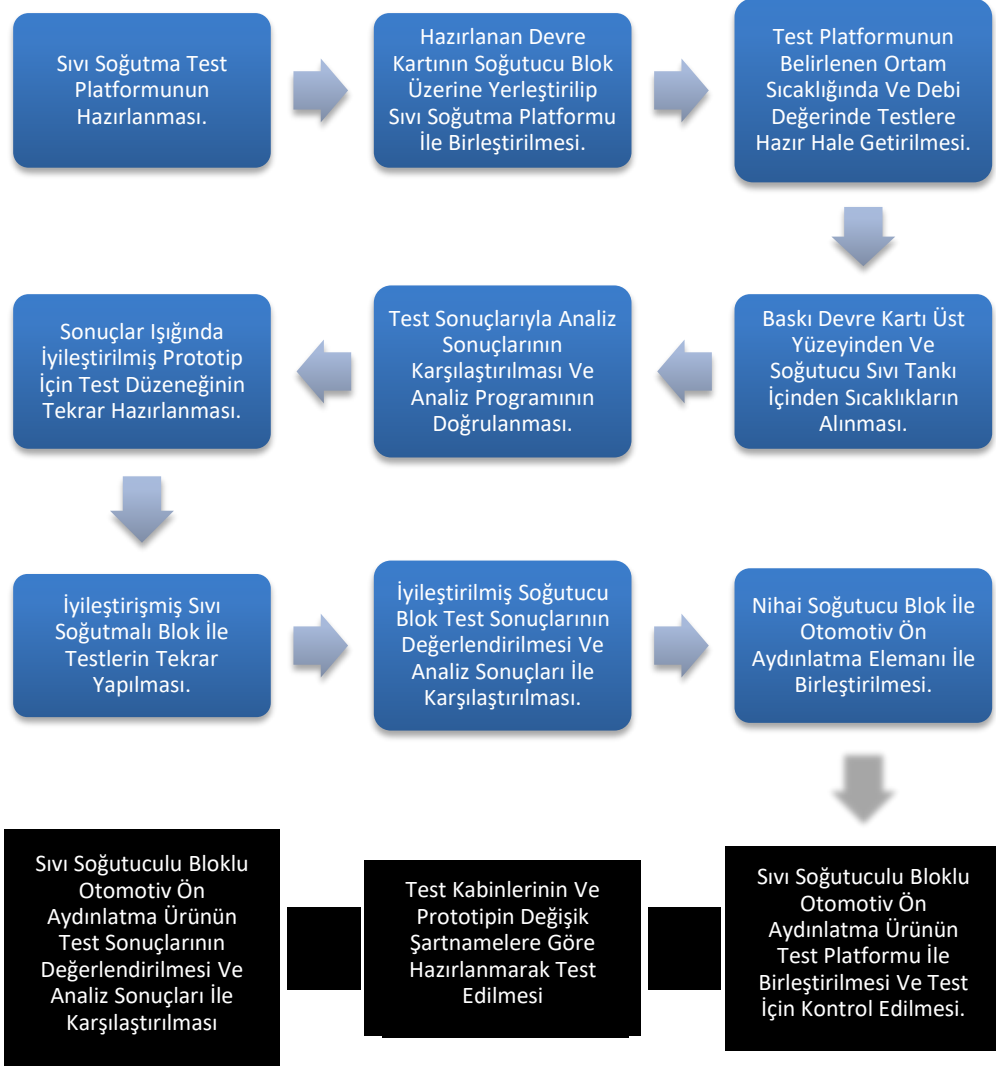
Şekil 3.18. Deneysel çalışmalar için iş akış şeması
