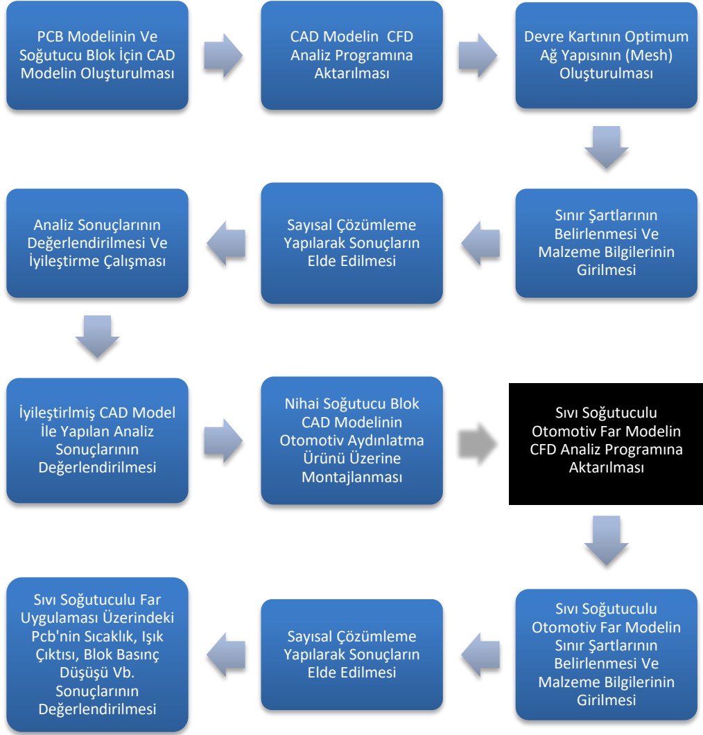
Şekil 3.5. Sayısal çalışmalar için iş akışı şeması
