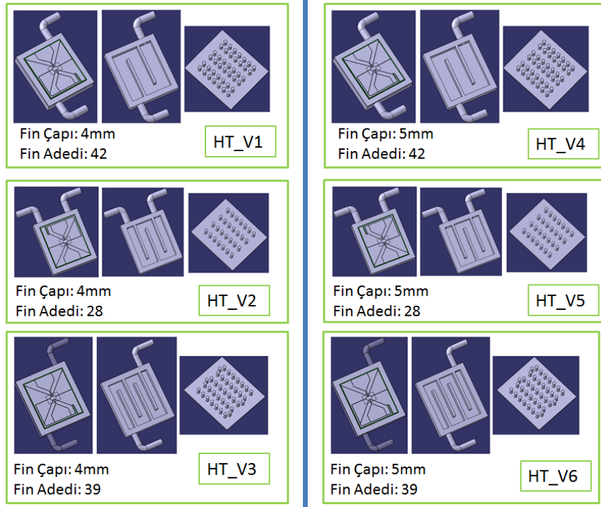
Şekil 3.12. İkinci aşama soğutucu blok tasarımları
