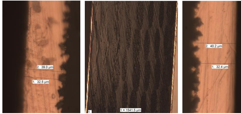
Şekil 3.25. Baskı devre kartının mikroskop ile kalınlık analizi
