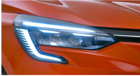
Şekil 2.7. Renault Clio Full LED uygulaması
