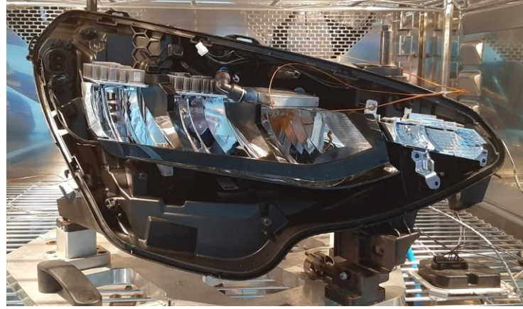
Şekil 3.31. Soğutucu blok tasarımının ön aydınlatma elemanında konumlandırılması
