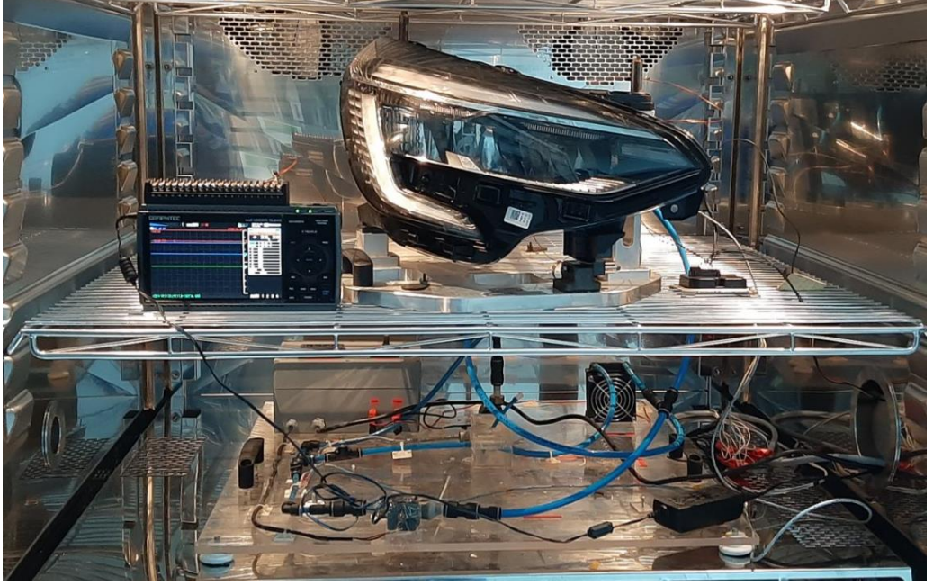
Şekil 3.33. Ön aydınlatma elemanı test düzeneği
