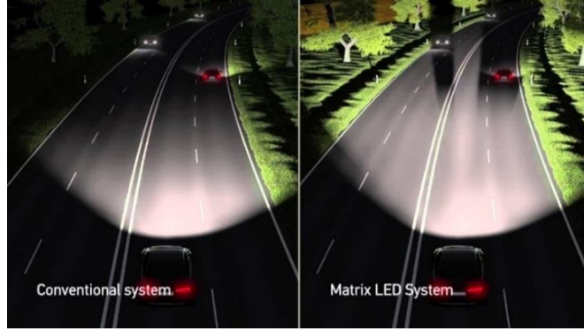
Şekil 2.6. Matrix far ve konvansiyonel far karşılaştırılması
