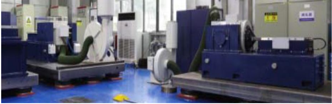
Şekil 2.10. Sarsıcılar için titreşim izolasyonu örneği
