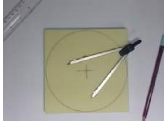
Pergel yardımı ile istenilen büyüklükte daire çizilir.
