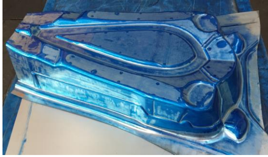
Şekil 3.32. Dişi kopyası tamamlanmış parçanın, alıştırma boyası ile kontrolü
