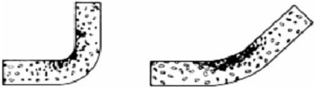
Şekil 2.25. Bükmenin sebep olduğu molekül hareketleri (Işıқтаş 2009)
