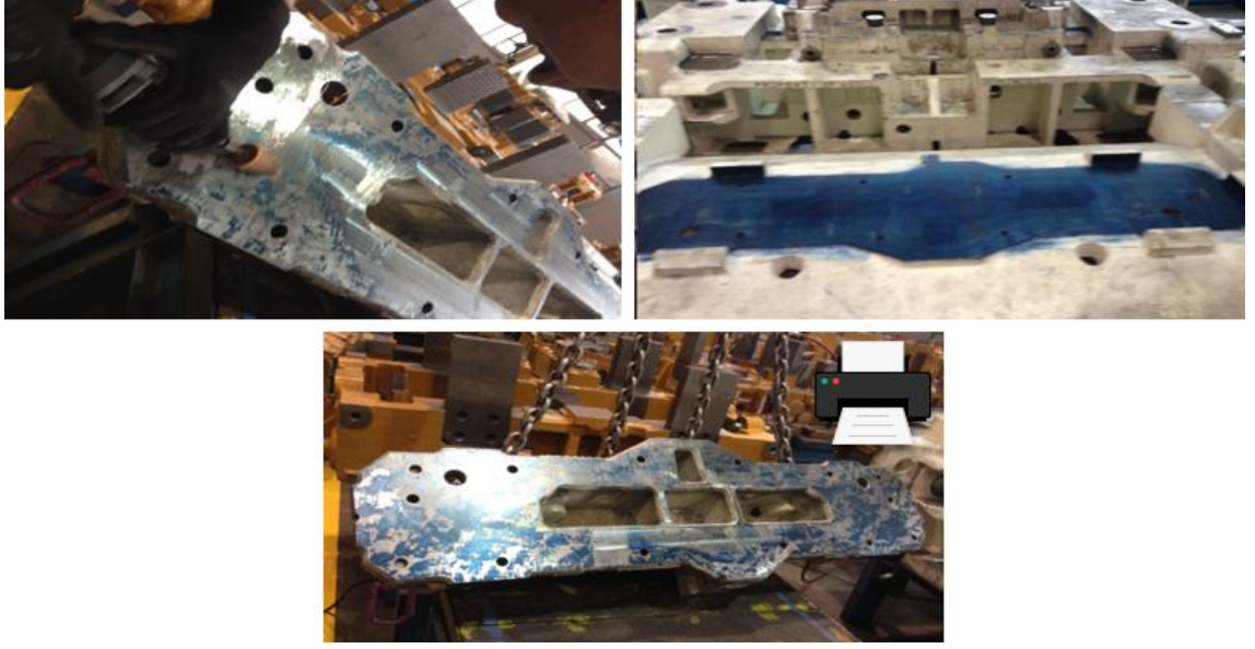
Şekil 3.27. Taban gönyeemesi tamamlanmış erkek göbek
