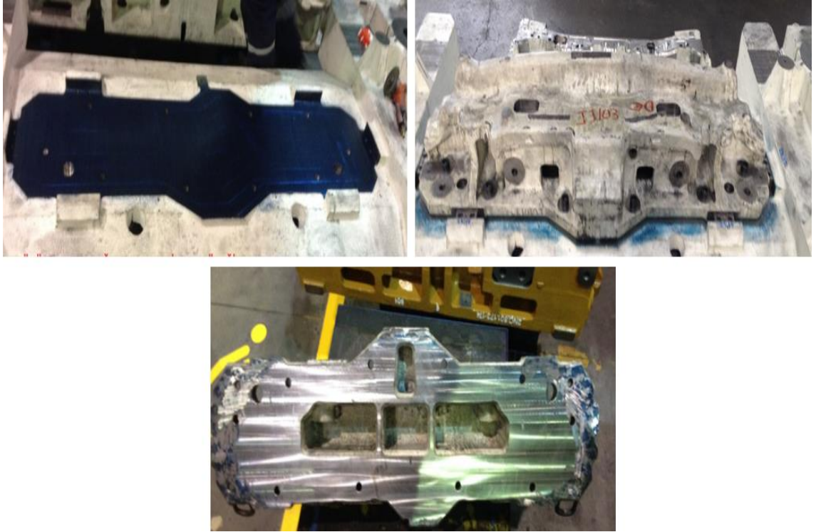
Şekil 3.26. Döküm göbeğinin, alıştırma boyası ile taban kontrolü
