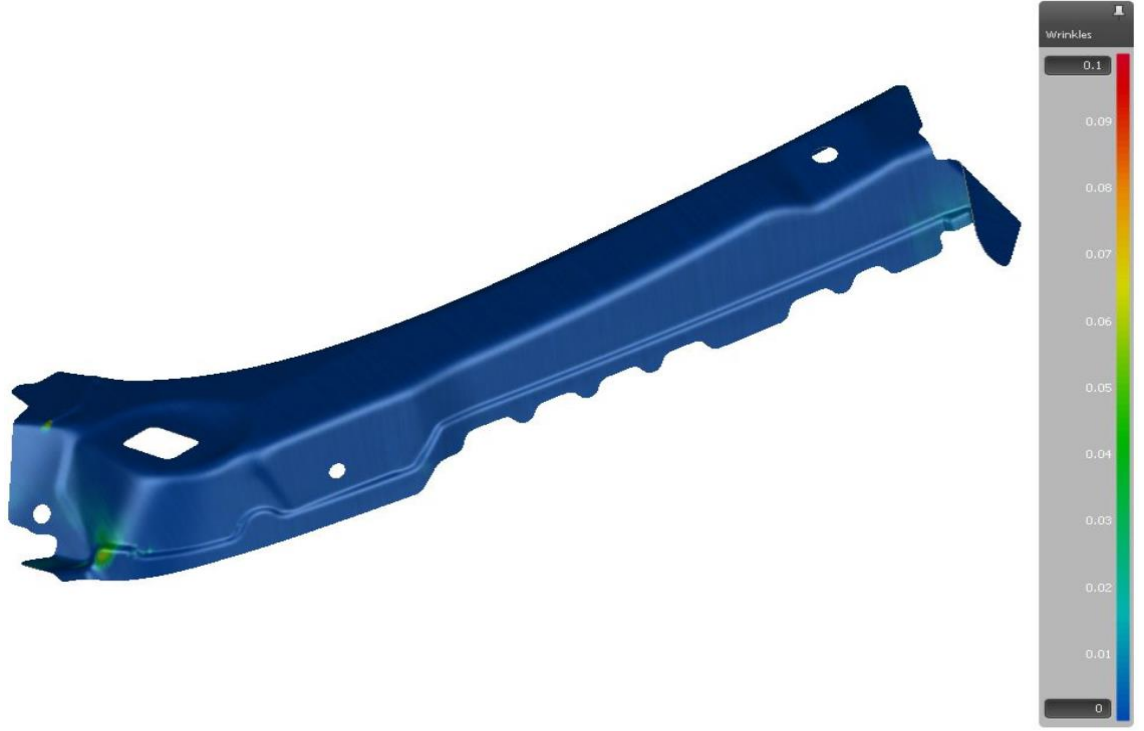
Şekil 4.4. Final parça üzerinde meydana gelen kırışma değerlerine ait simülasyon sonuçları
