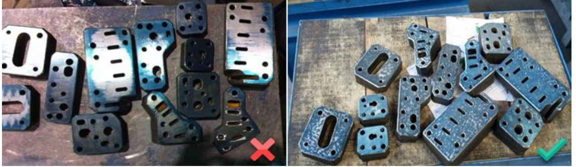
Şekil 3.28. Taban gönyeemesi tamamlanmış kesme çelikleri
