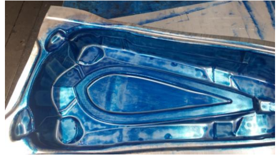
Şekil 3.32. Dişi kopyası tamamlanmış parçanın, alıştırma boyası ile kontrolü
