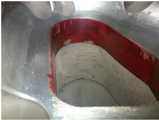
Şekil 3.36. Alt kesme çeliklerinde, markalama boyası ile kesme boşluğu kontrolü
