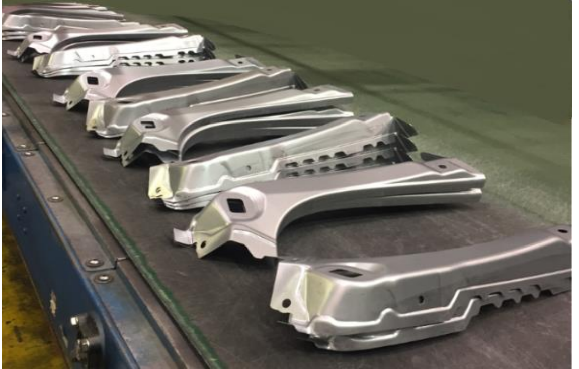
Şekil 3.41. Bükme kalıbından çıkmış sağ-sol final parçaları
