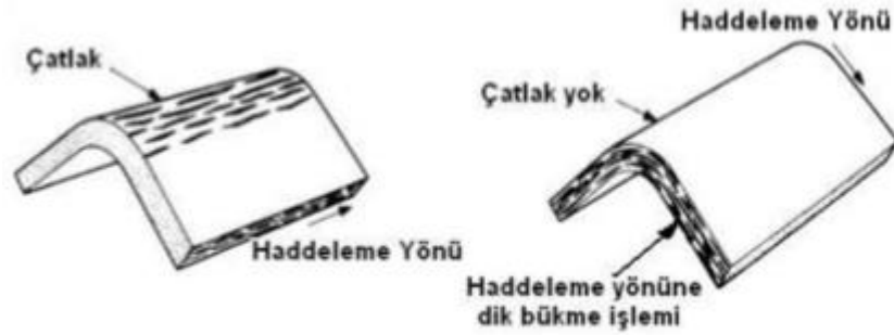
Şekil 3.3. Haddelenme yönü ve bükme işlemi (Çapan 2003)
