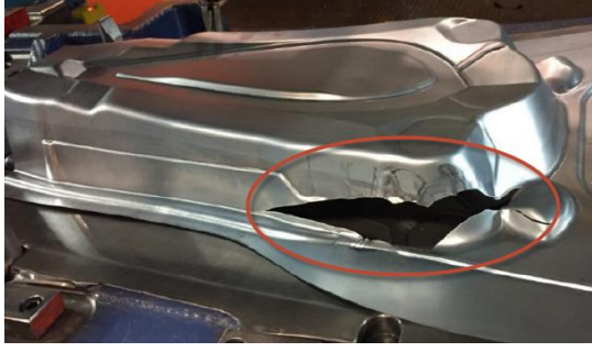
Şekil 3.31. Alıştırması tamamlanmamış derin çekme parçası
