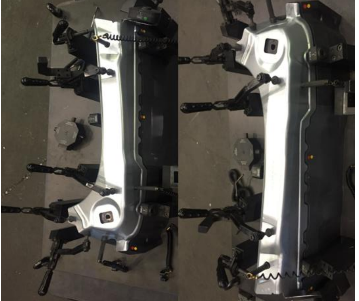
Şekil 4.6. Parçaların kontrol fikstürleri üzerinde sabitlenmesi
