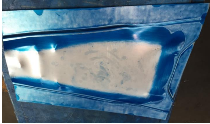
Şekil 3.30. Pot kopyası tamamlanmış parçanın, alıştırma boyası ile kontrolü
