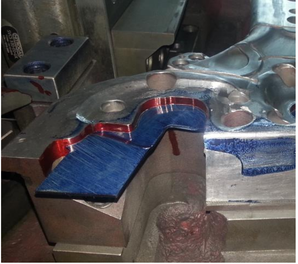
Şekil 3.39. Hurdanın alt kesme çeliğinde takılması durumu
