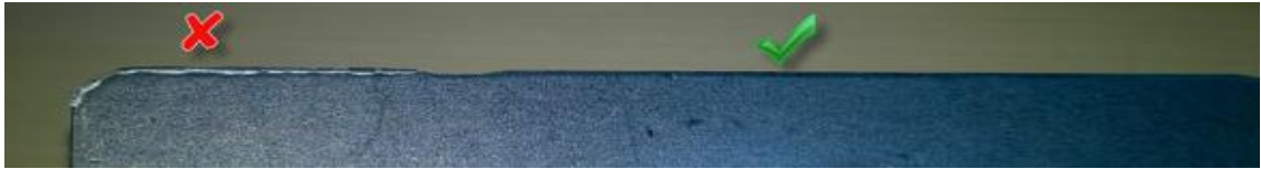
Şekil 3.38. Kesme boşluğu sebebiyle oluşan çapak problemi
