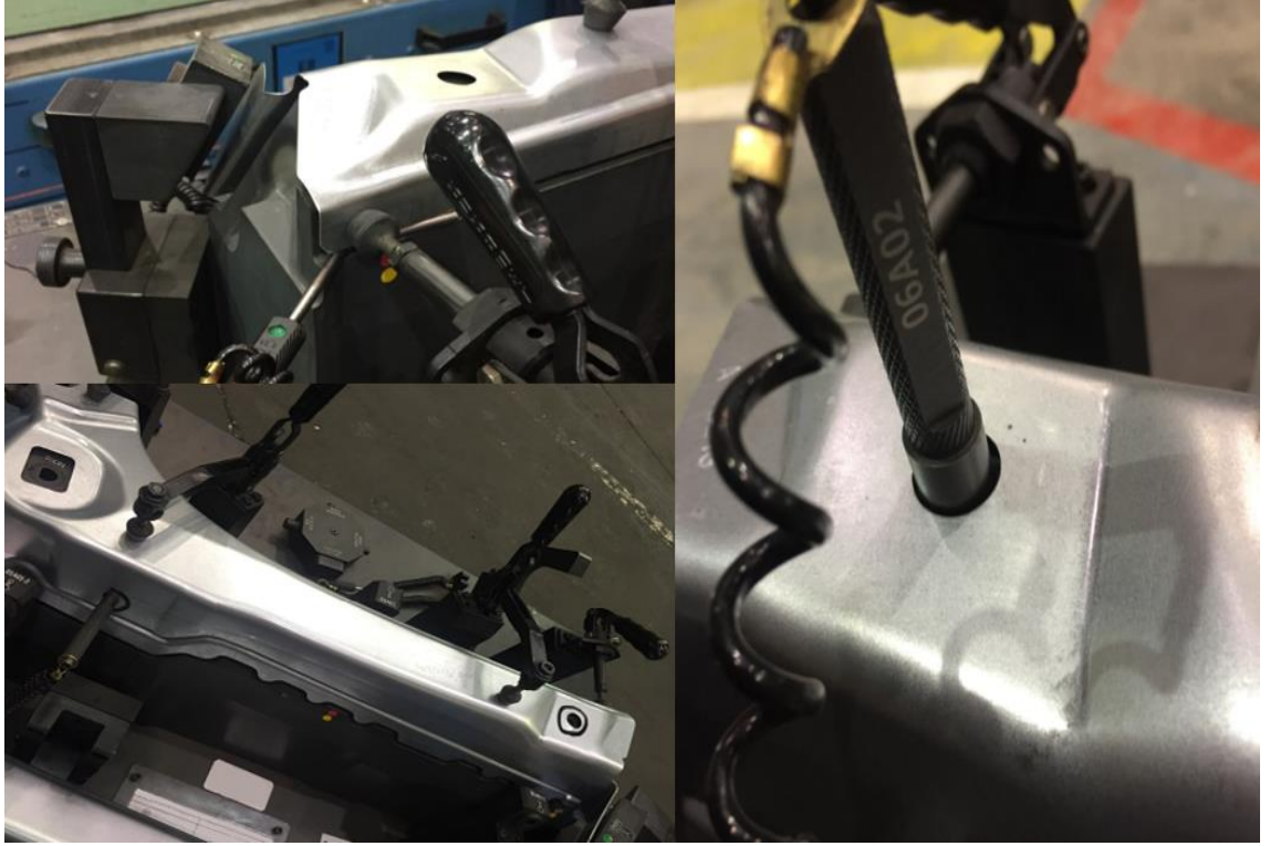
Şekil 4.7. Fikstür üzerinde yardımcı aparatlar kullanılarak yapılan kontroller
