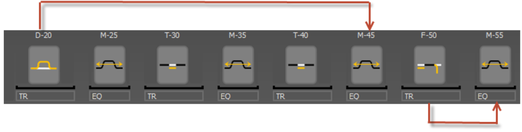
Şekil 3.13. Geri yaylanma telafi verme yöntemi
