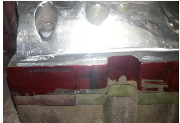
Şekil 3.36. Alt kesme çeliklerinde, markalama boyası ile kesme boşluğu kontrolü
