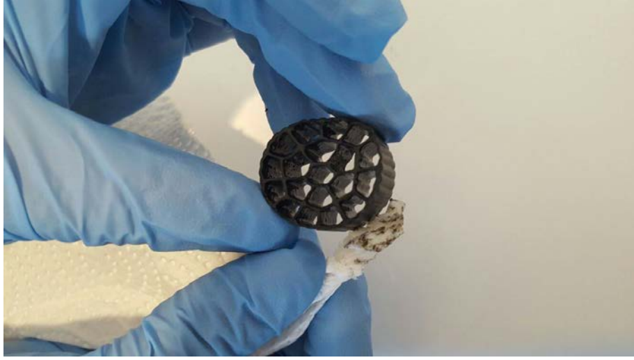
Şekil 3.5. Bir aylık uygulamanın ardından HYBR yüzeyinde oluşan mikroorganizma
