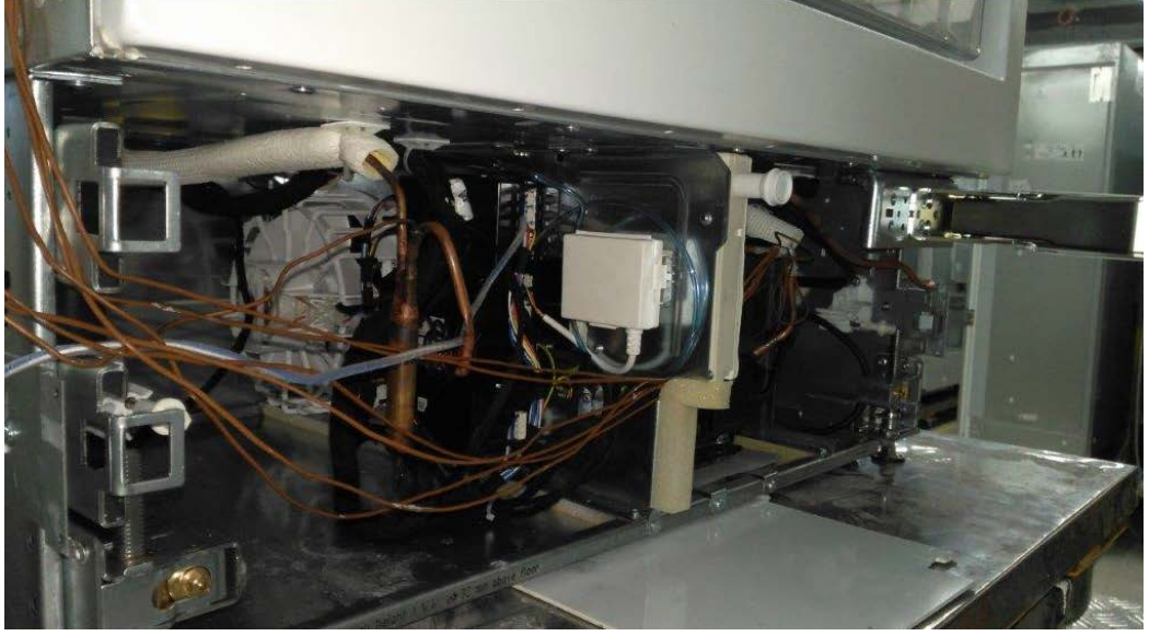
Şekil 3.33. Makine odasındaki ısıl çift bağlantısı
