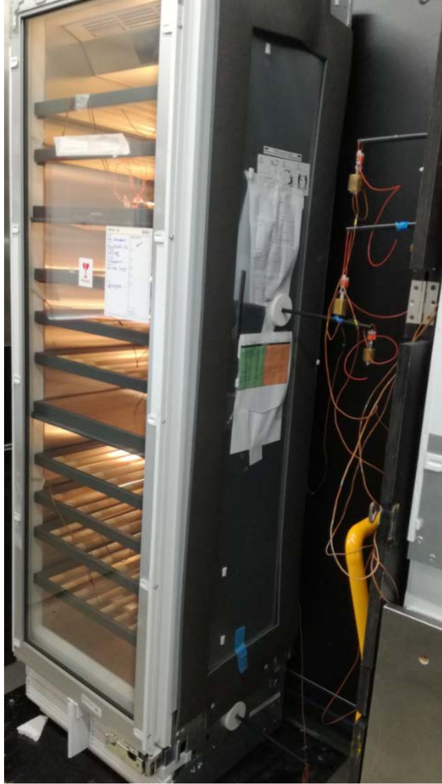
Şekil 3.32. US standardına göre test elemanları bağlantısı
