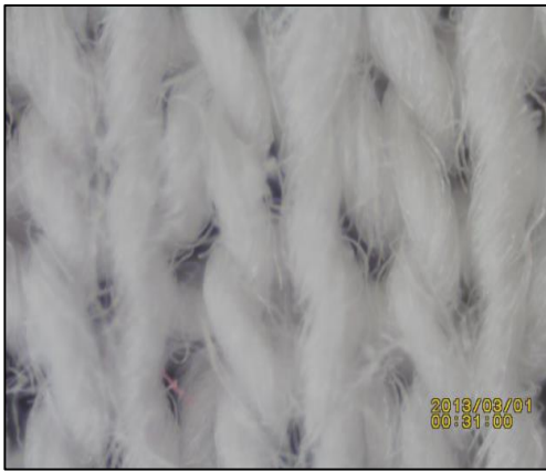
Şekil 3.5. 2. Grup kumaş numunelerinin mikroskopik görüntüleri ( x 4 Büyütme)
