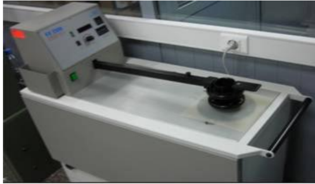
Şekil 2.2. Hava Geçirgenliği Test Cihazı (Anonim 2019)
