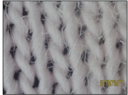
Şekil 3. 2. 1. Grup kumaş numunelerinin mikroskobik görüntüleri (x 4 büyütme)
