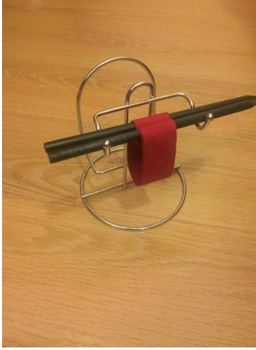
Şekil 3.8. "Kalp ilmek metodu" ile eğilme rijitliği ölçüm düzeneği
