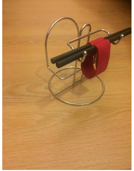
Şekil 3.8. "Kalp ilmek metodu" ile eğilme rijitliği ölçüm düzeneği
