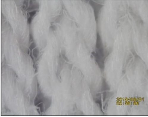
Şekil 3.6. 2. Grup kumaş numunelerinin mikroskopik görüntüleri (x 4 büyütme) (devamı)
