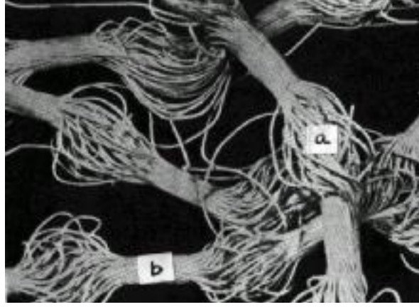
Şekil 2.19. Moleküler zincirler boyunca kristalin ve amorf bölgeler modeli, (a)amorf bölgeler, (b)kristalin bölgeler (Atkinson 2003)
