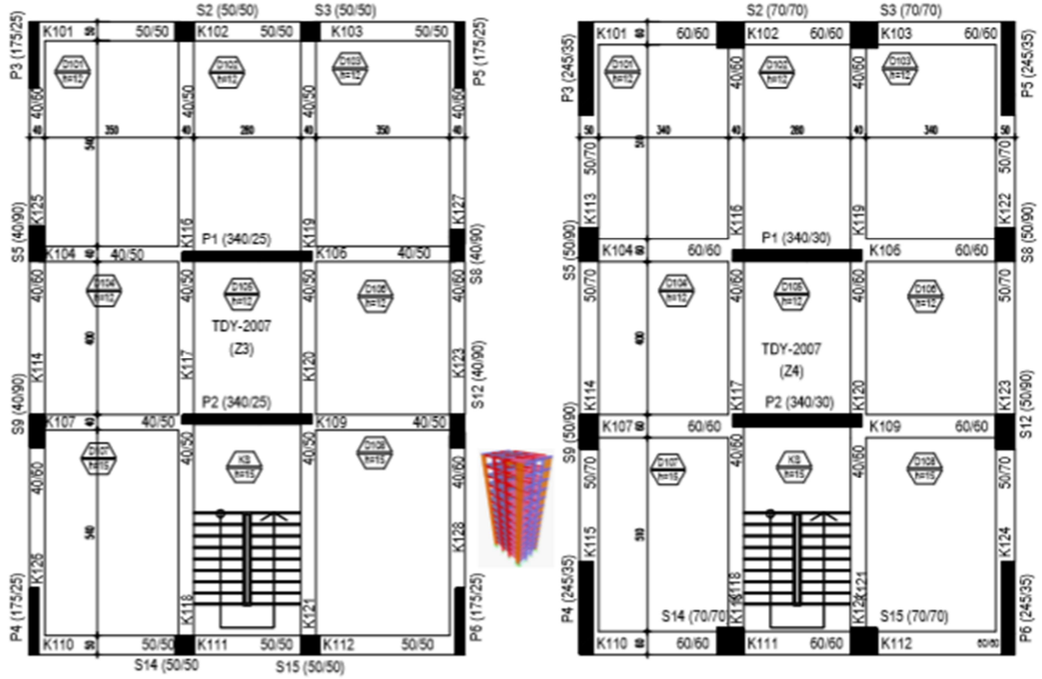
Şeki B.6. Grup-6 (13 katlı perde- çerçeve türü) Modellerine ait kat kalıp planları.
