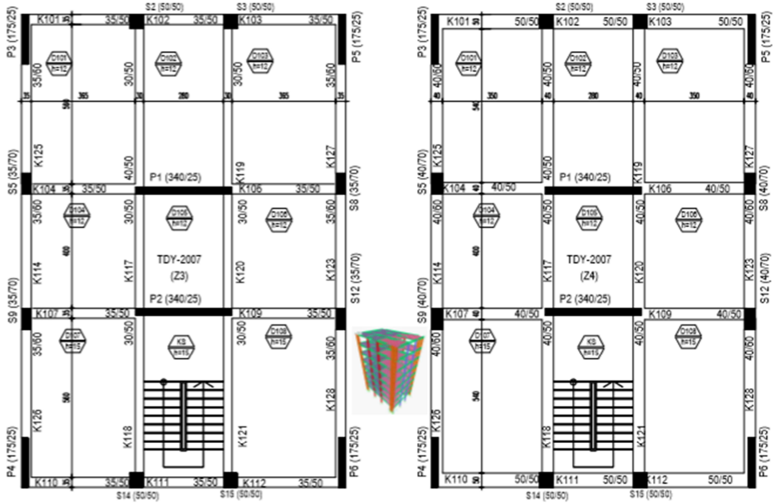
Şeki B.4. Grup-4 (8 katlı perde-çerçeve türü) Modellerine ait kat kalıp planları.
