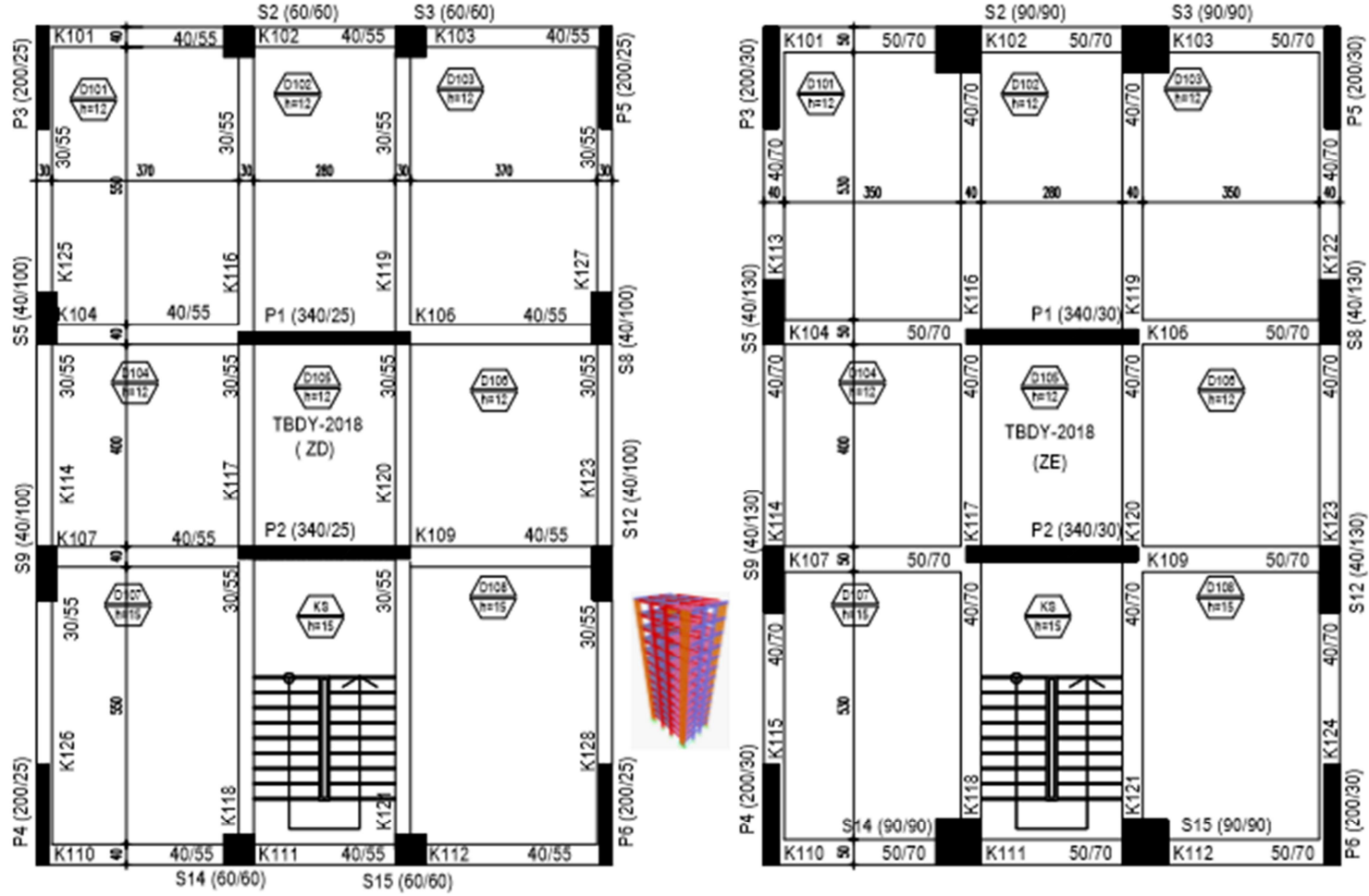
Şeki C.6. Grup-6 (13 katlı perde-çerçeve türü) Modellerine ait kat kalıp planları.
