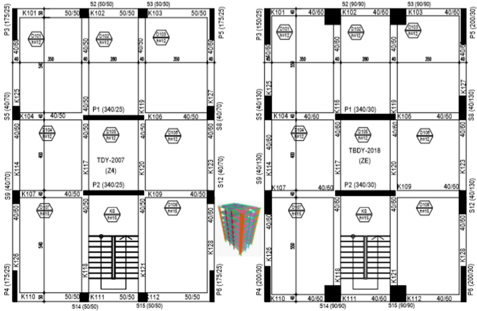
Şekil 4.17. Grup-4 (8 katlı çerçevesel-perdeli) örneklerin kat kalıp planları Z4 ve ZE zemin sınıfları için
