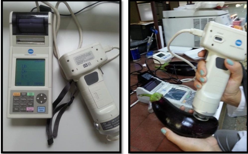
Şekil 3.12. Renk ölçer cihazı
