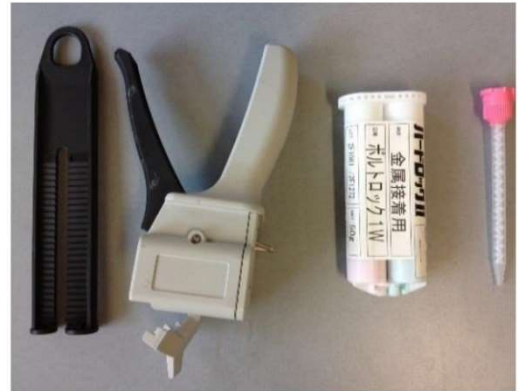
Şekil 3.2. Kazıkların kaplamasında kullanılan özel yapıştırıcı 'hard rock' (Ünsever 2015)
