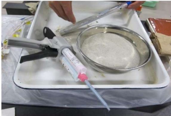
Şekil 3.2. Kazıkların kaplamasında kullanılan özel yapıştırıcı 'hard rock' (Ünsever 2015)
