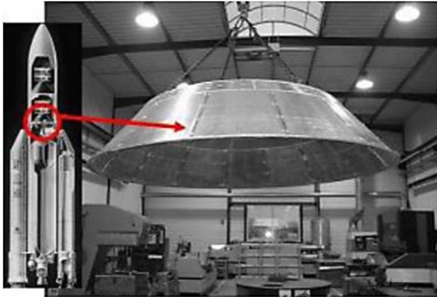
řekil 2.9. Sandvi kpk panelden yapılmıř bir roket konisi (Anonim 2018b)
