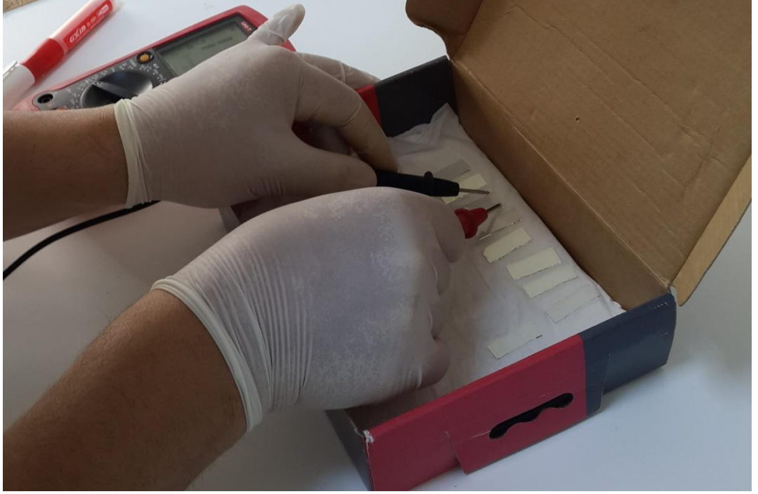
Şekil 3.2. Üretim öncesi kesilen alttaşların kaplama yapılacak yüzeyinin kontrolü
