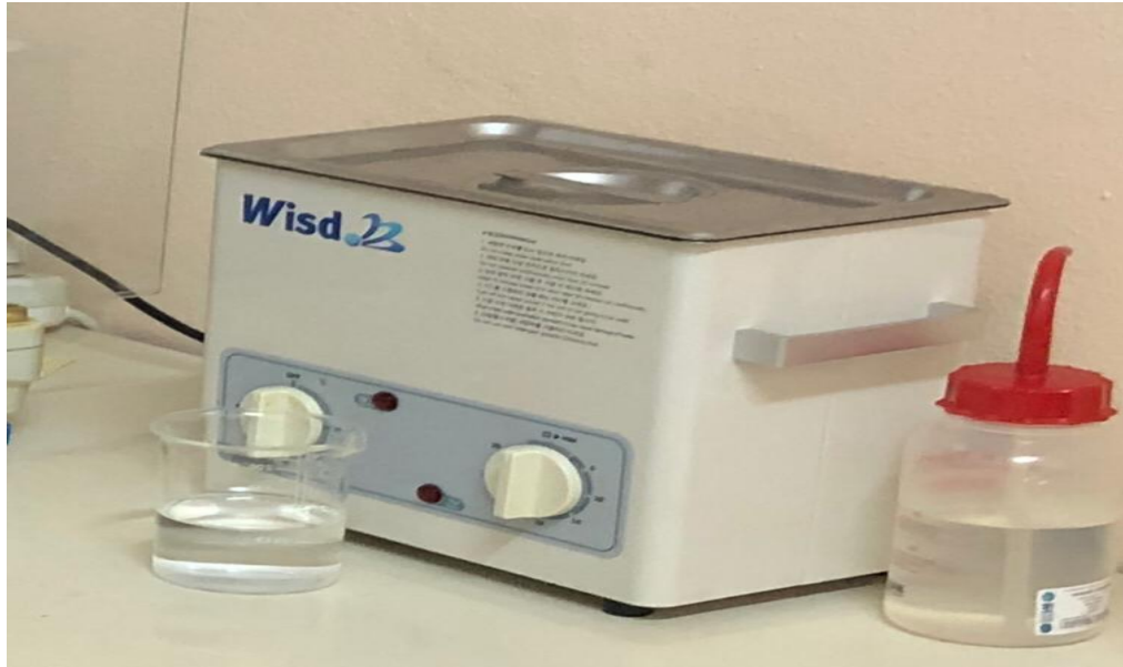
Şekil 3.1. Zaman ayarlı ultrasonik temizleme cihazı
