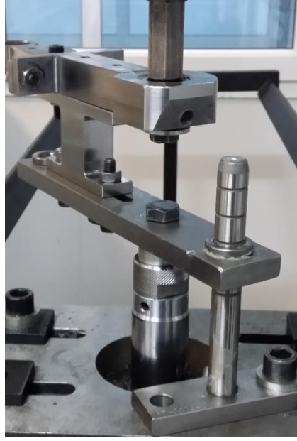
Şekil 4.10. Eksenel statik test düzeneği
