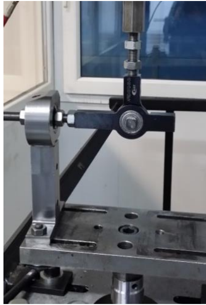
Şekil 4.11. Kardanik statik test düzeneği
