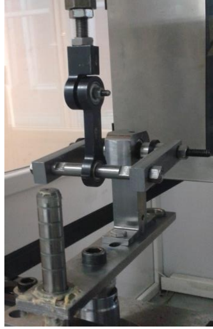
Şekil 4.12. Torsiyonel statik test düzeneği
