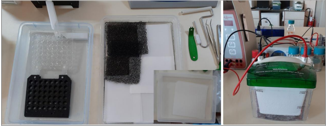
Şekil 3.13. Transfer materyallerinin hazırlanması ve ıslak transferin gerçekleştirilmesi
