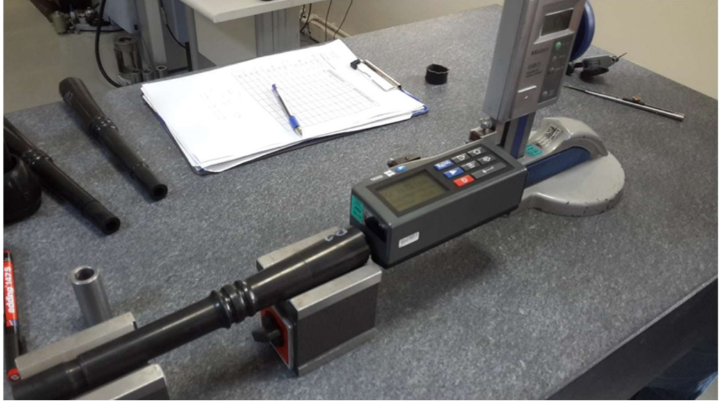
Şekil 3.7. Yüzey pürüzlülük cihazı ile meme lastiği iç yüzeyinde pürüzlülük analizi
