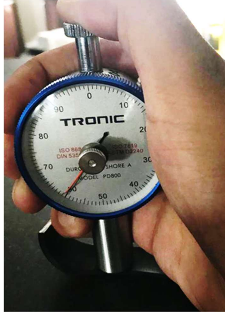
Şekil 3.6. Sertlik ölçme cihazının kauçuk parça üzerine uygulanışı
