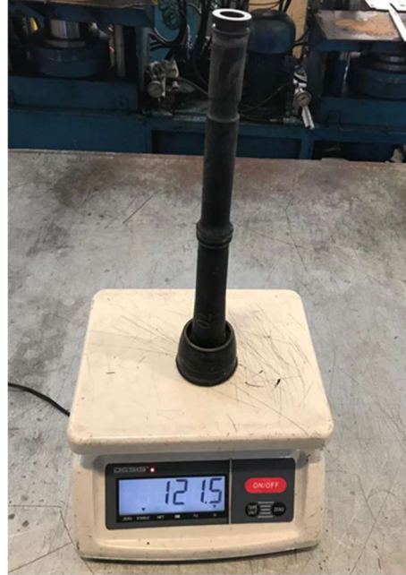
Şekil 3.8. Meme lastiğinin dijital terazide ölçümü
