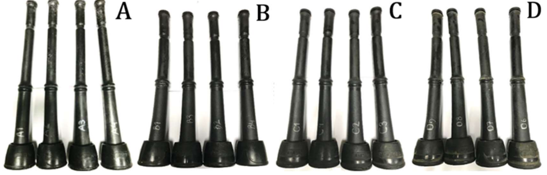
Şekil 3.2. Araştırmada kullanılan farklı ömürlerdeki meme lastikleri (A-Yeni; B-1250 sağım ömrü; C-2500 sağım ömrü; D-3500 sağım ömrü)
